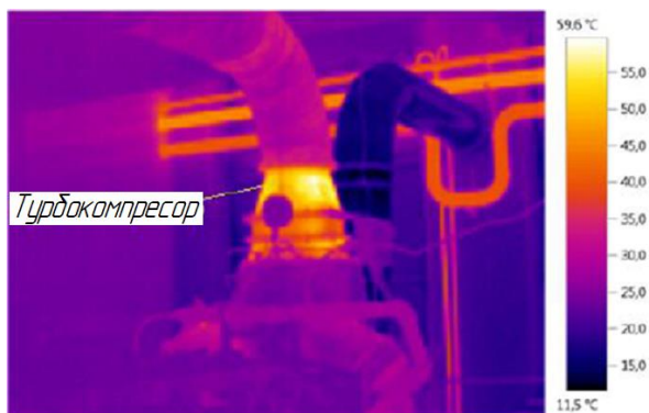
Рис. 2. Термограма розподілу температур при прогріванні дизельного двигуна (температура води 24^{\circ}\text{C} )
