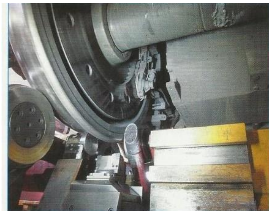
Рис.3 – Вимірювання профілю та діаметру колісної пари при обкатці на його контрольним роликком на колесо-токарному верстаті.
