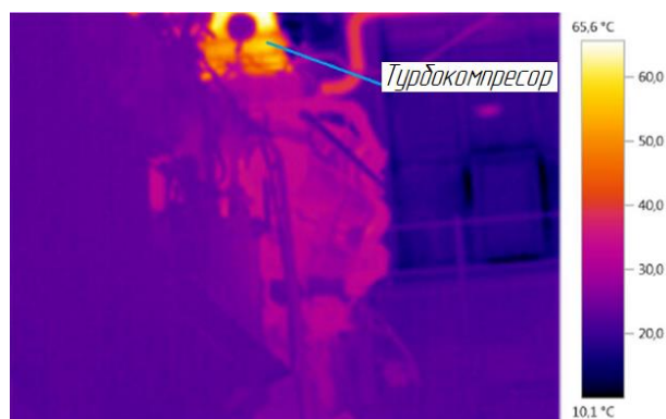
Рис.5. Термограма розподілу температур при прогріванні дизельного двигуна (температура води 39°C)
