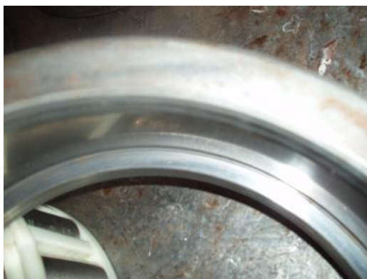
Рис. 1.Корозійні пошкодження зовнішнього кільця.
