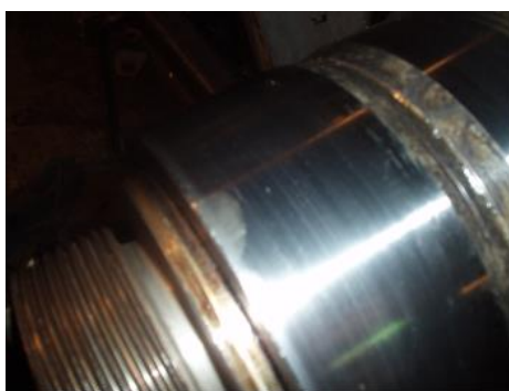
Рис. 3. Кругові риски на доріжці кочення внутрішнього кільця.
