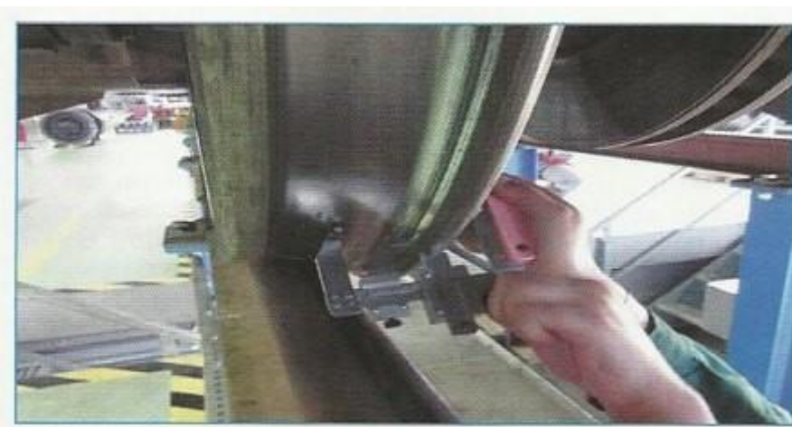
Рис.1 – Вимірювання геометричних параметрів колісної пари універсальним шаблоном УТ-1.
