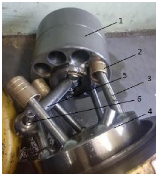
Рис. 3. Елементи циліндро-поршневої групи та шатунно-поршневої групи аксіально-поршневої гідромашини МН250/100
