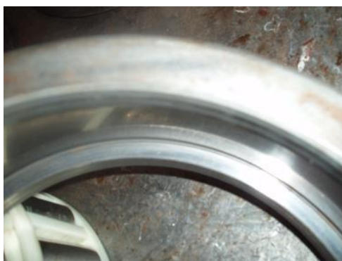
Рис. 2.Задири та знос на борту зовнішнього кільця.
