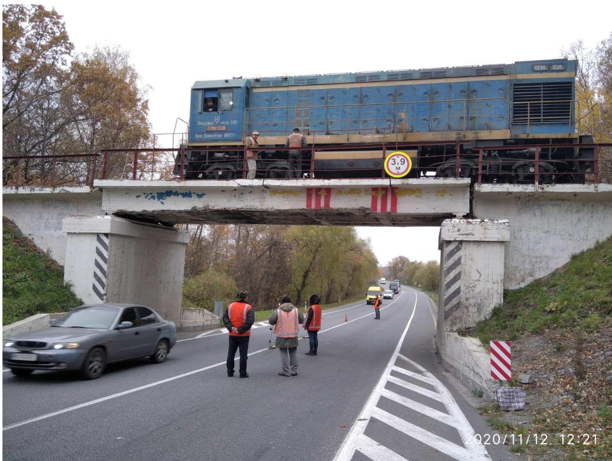
Випробування шляхопроводу тепловозом ТГМ6 а заводський № 1508
