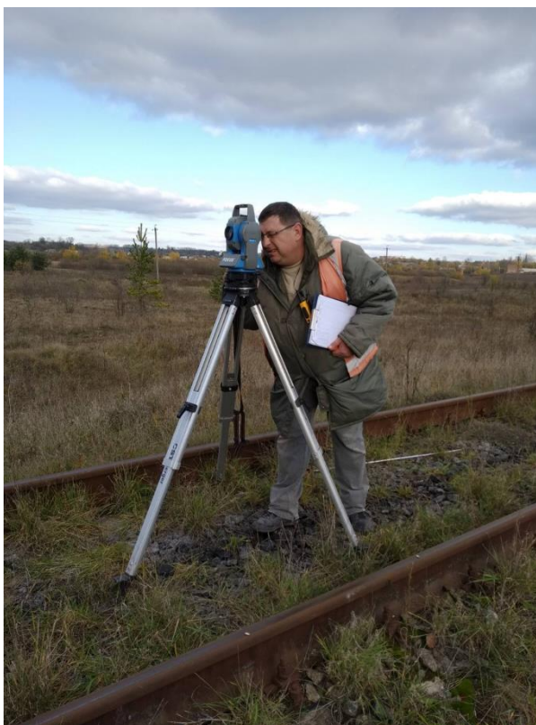
Зйомка плану і профілю під'їзних залізничних колій доцентом кафедри будівельних матеріалів, конструкцій та споруд В.А. Лютим
