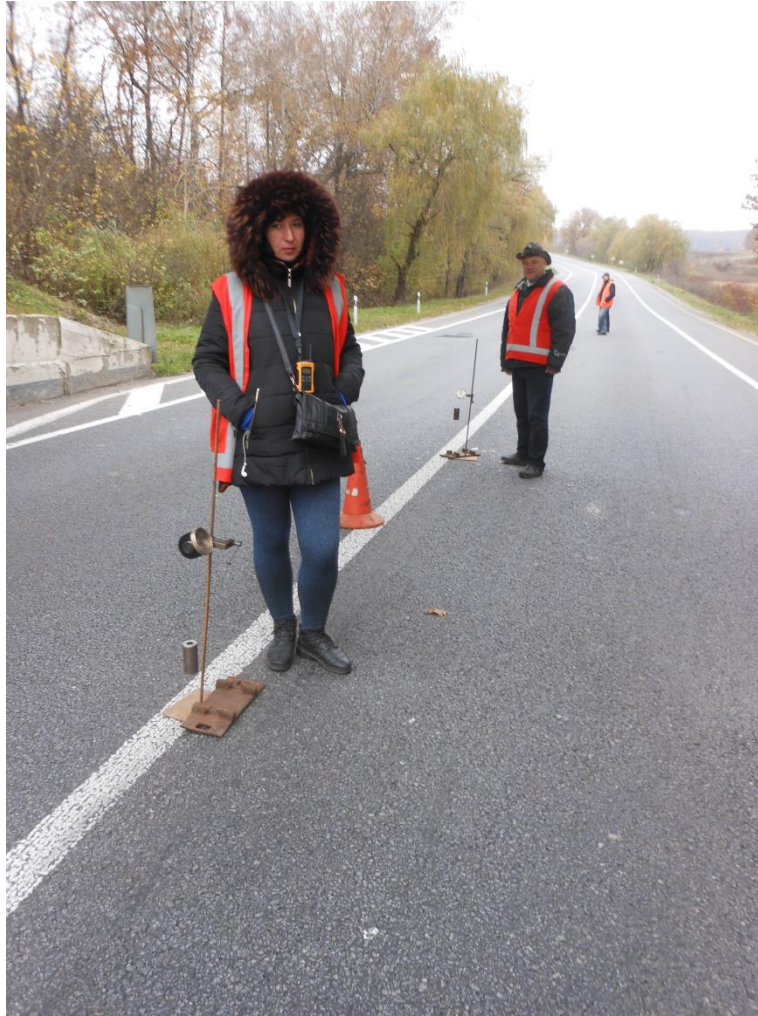
Співробітники кафедри будівельних матеріалів, конструкцій та споруд біля встановлених прогиномірів ПМ-3
