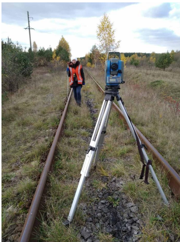
Зйомка плану і профілю під'їзних залізничних колій науковим співробітником кафедри будівельних матеріалів, конструкцій та споруд Ю.Ю. Савчук
