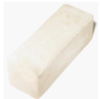
Рис. 2.4 Форма зі зразками-призмами і зразок-призма розміром 40 \times 10 \times 10 мм
