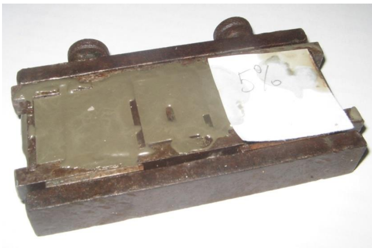
Рис. 2.4 Форма зі зразками-призмами і зразок-призма розміром 40 \times 10 \times 10 мм
