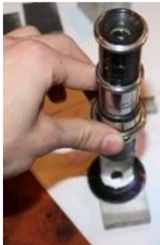
Рис.2.3 Вимірювання товщини покриттів: а – зразок-балочка з покриттям та надрізами; б – вимірювання товщини покриття відліковим мікроскопом МПБ-2; в – розріз покриття, \times 24
