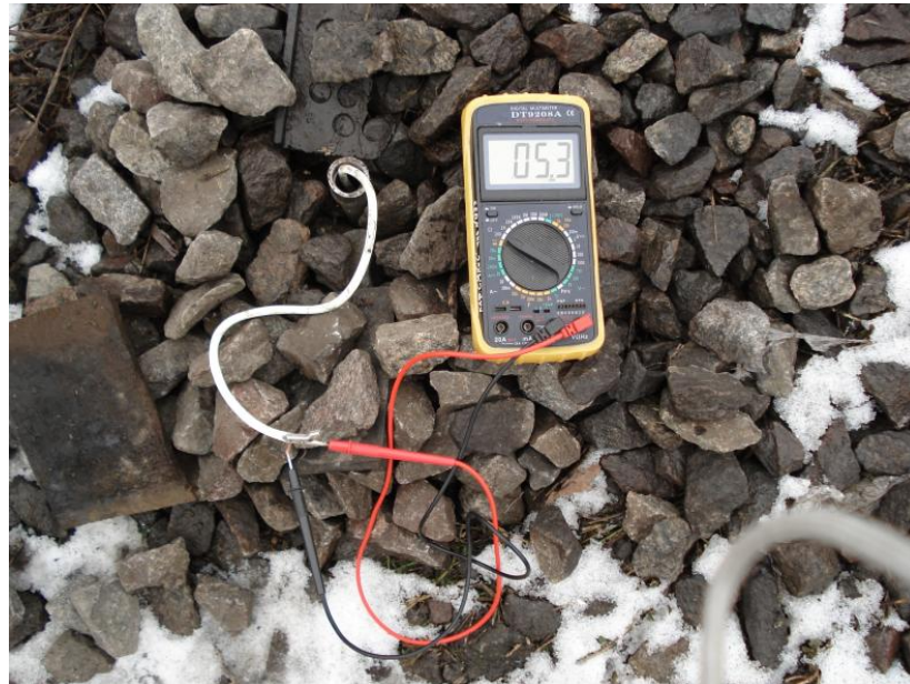
Рис. Д.2 Вимірювання електричного опору зануреного у ґрунт датчика цифровим мультиметром (перетворювачем аналогового сигналу в цифровий)
