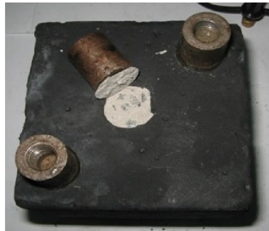
Рис. 2.4 Вимірювання адгезії до бетону: а – штампи, наклеєні на зразок бетону; а – вимірювання адгезії адгезіометром Оникс-АП; б – зразок бетону, приготовлений для визначення адгезії; в – когезійний відрив по бетону
