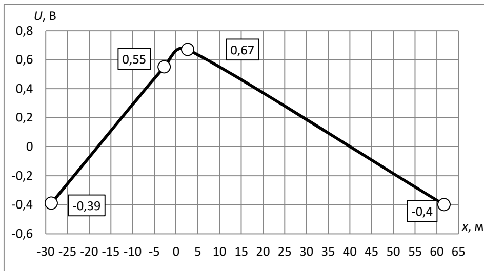
Рис. 1.7 Розподіл електричних потенціалів навколо будівлі водозабірної свердловини на ст. Основа: а – схема будівлі та місцевості навколо неї; б – розподіл потенціалу по місцевості (за координату x = 0 прийнято вісь свердловини)
