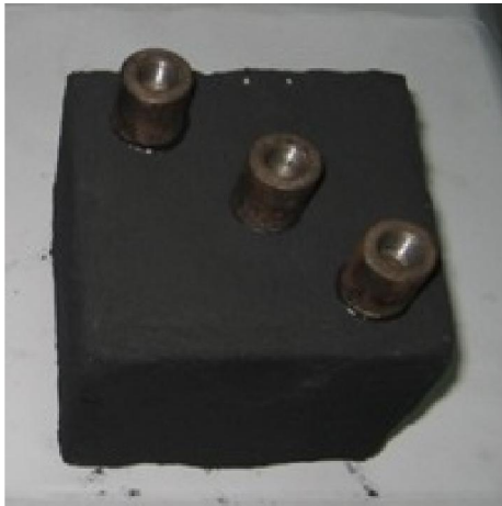
Рис. 2.4 Вимірювання адгезії до бетону: а – штампи, наклеєні на зразок бетону; а – вимірювання адгезії адгезіометром Оникс-АП; б – зразок бетону, приготовлений для визначення адгезії; в – когезійний відрив по бетону
