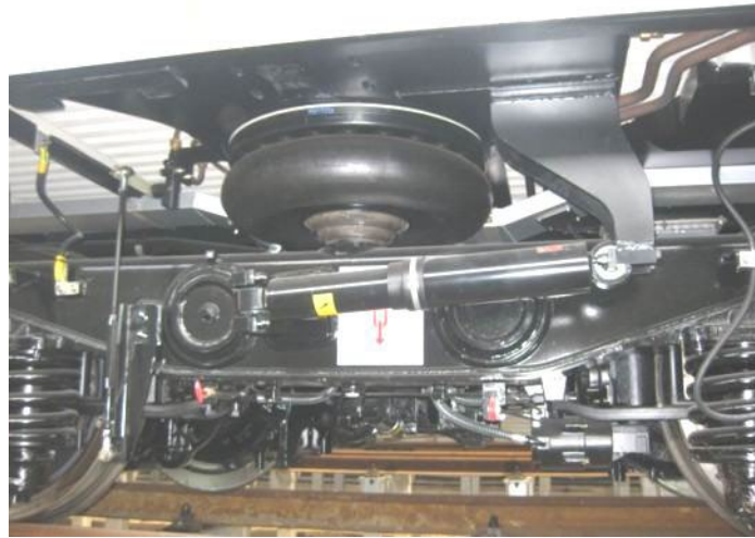
Рис. 2.7 Загальний вигляд вузлів другого ступеня ресорного підвішування електропоїзда НRCS2.
