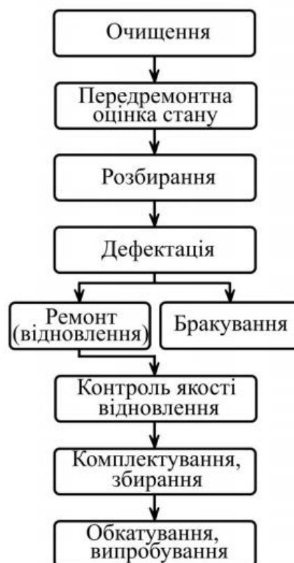
Рисунок 3.7 - Схема виробничого процесу ремонту вузла локомотива
