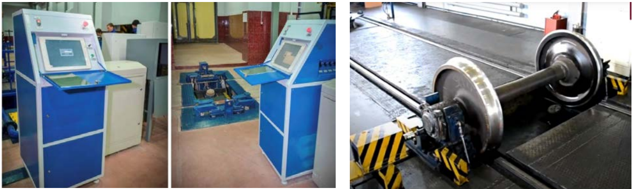
Рисунок 1.7 — Комплекс діагностування буксових вузлів колісних пар РС «Експерт Д»
