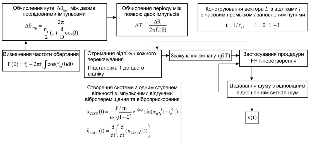
Рисунок 2.1 — Алгоритм числової реалізації моделі вібрації підшипника
