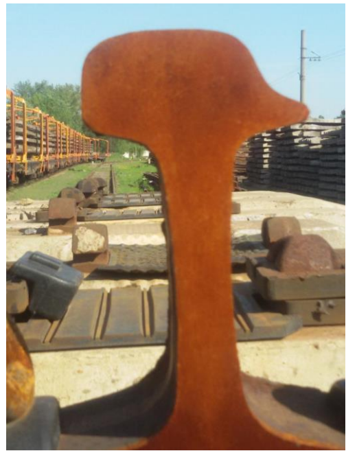
Рис. 4.2. Приклад бічного зносу головки рейки до 10 мм
