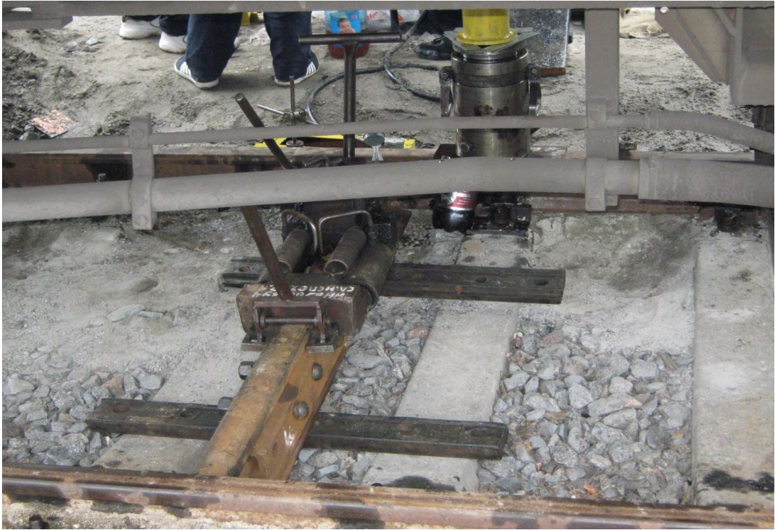
Рис. 2.12. Встановлення розгінного пристрою для створення та контролювання розрахункових значень бічних навантажень на головку рейкової нитки
