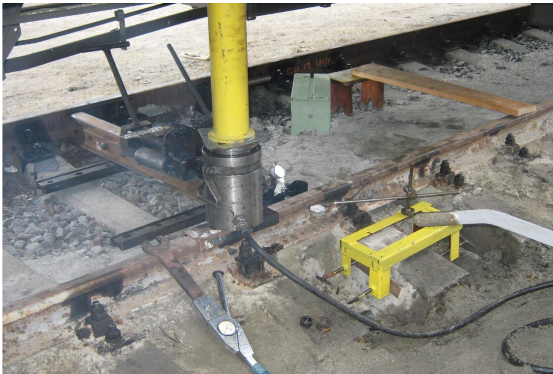
Рис. 2.13. Експериментальна установка для створення та контролювання одночасних розрахункових вертикальних та бічних навантажень з одночасним контролюванням горизонтальних бічних відтиснень головки рейкової нитки (вид зліва)
