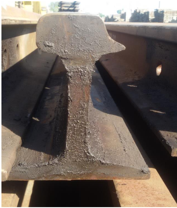
Рис. 4.1. Приклад бічного зносу головки рейки на 15 мм без утворення полочки
