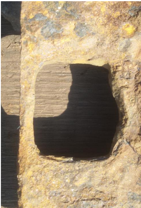
Рис. 2.3. Корозійне ушкодження отвору підкладки
