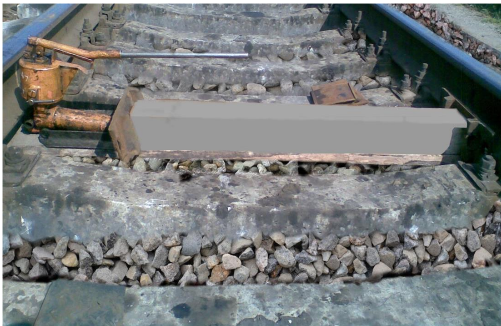
Рис 2.1. Устаткування для вимірювання горизонтальних люфтів
