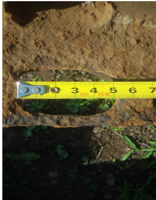
Рис. 2.3. Корозійне ушкодження отвору підкладки
