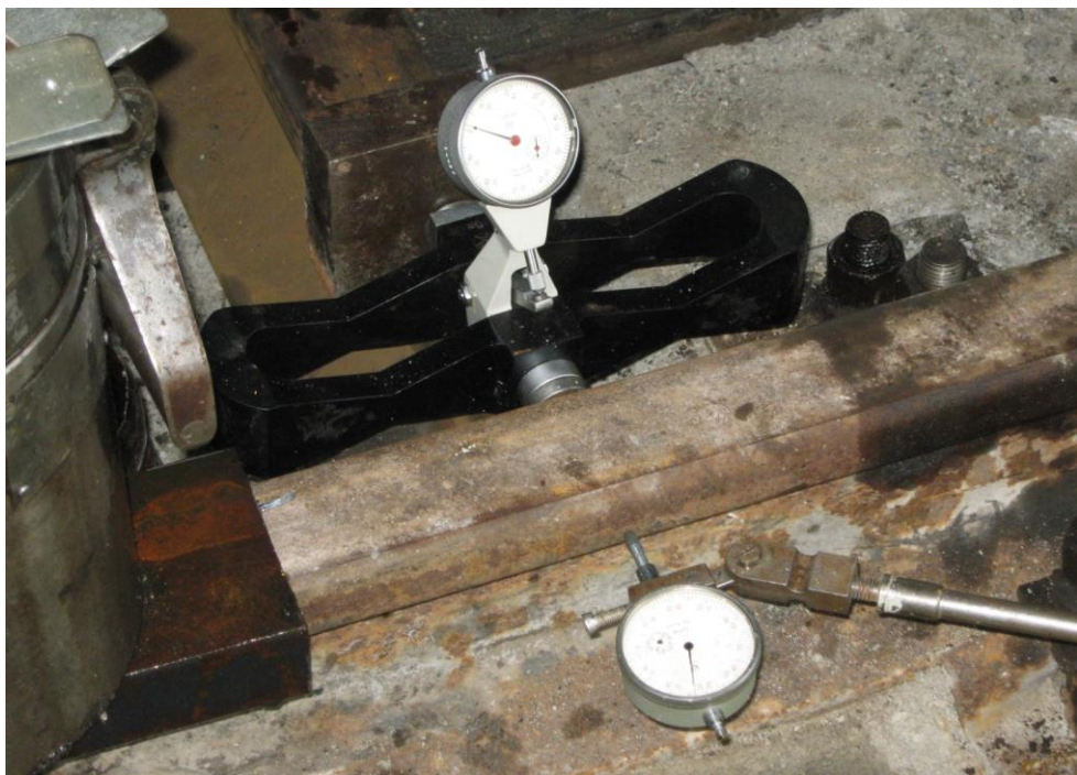
Рис. 2.11. Установка динамометра ДОСН-5 з індикатором годинникового типу ИЧ-1 для контролю переданих горизонтальних зусиль
