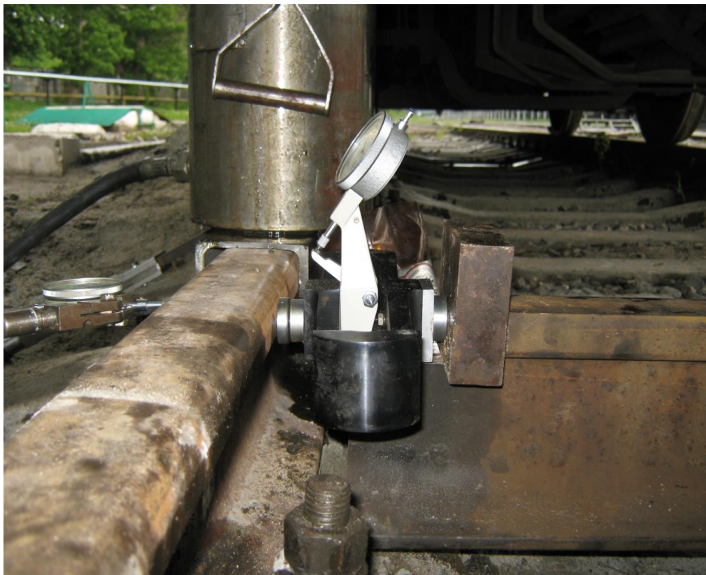
Рис. 2.9. Місце передачі бічного навантаження і контролю горизонтальних переміщень (вид збоку)
