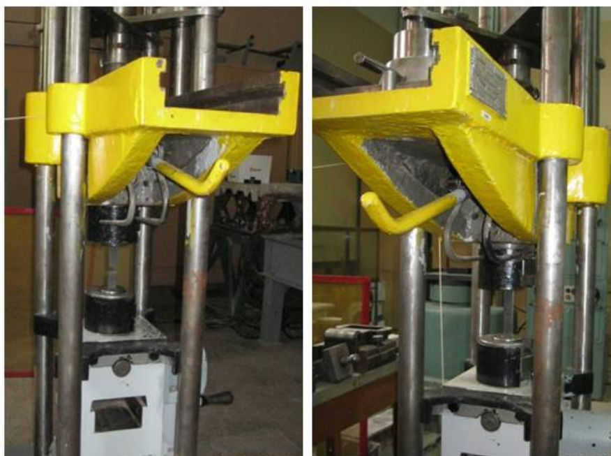
Рис. Г5. Випробування стандартних заготовок металу на випробувальній машині УІМ-50
