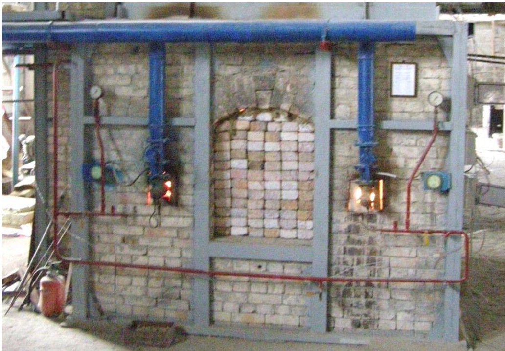
Рис. 3.9. Вигляд печі під час випробування колони
