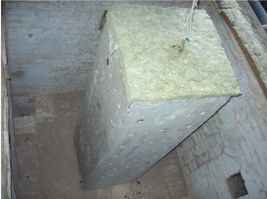
Рис. 3.10. Вигляд колони (зразок №1) в печі після випробування
