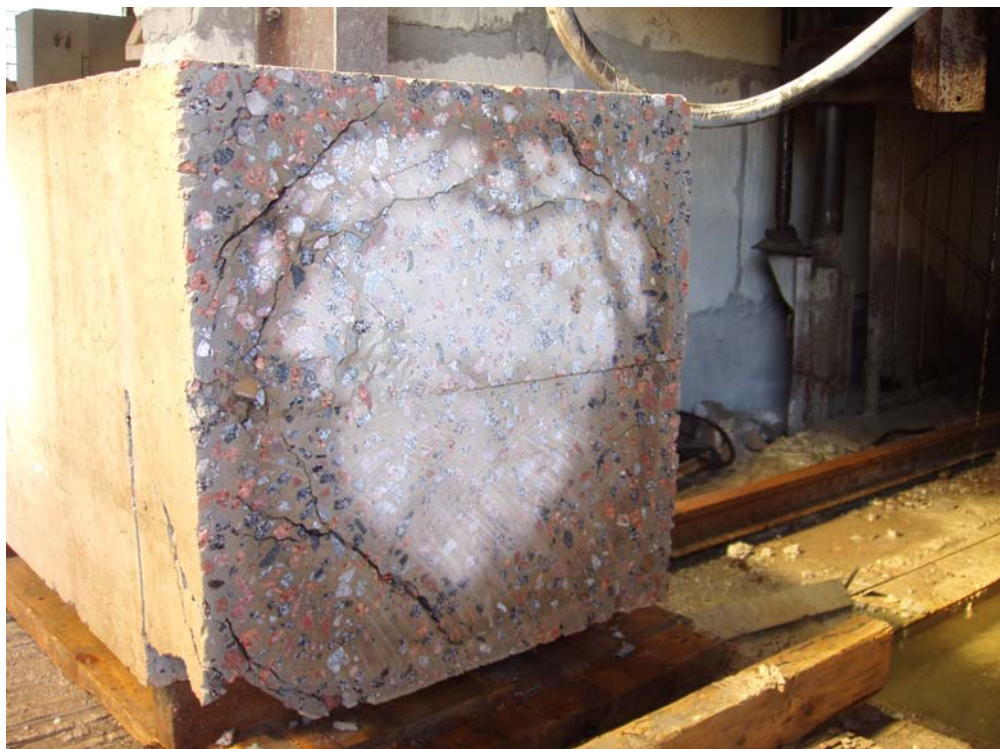
Рис. 3.17. Переріз колони після розрізання
