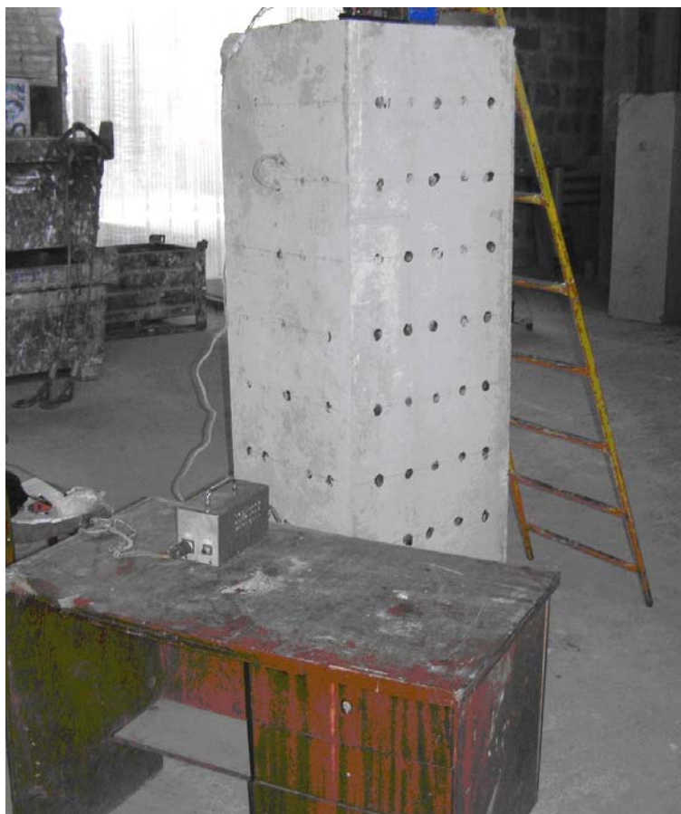
Рис. 3.8. Обладнання для досліджень бетону ультразвуковим методом
