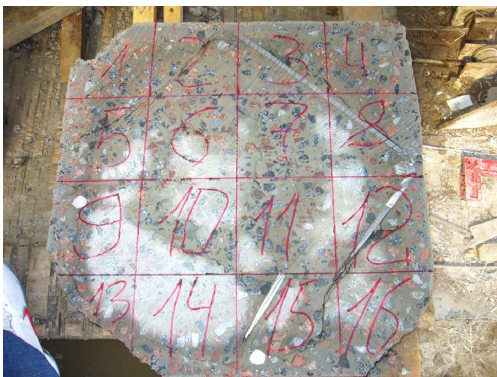
Рис. 3.17. Переріз колони після розрізання
