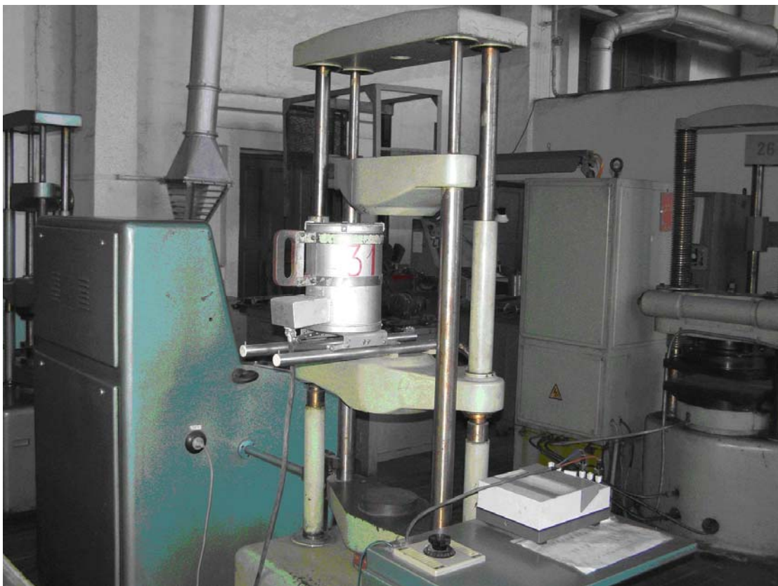
Рис. 3.3. Обладнання для випробувань зразків арматури
