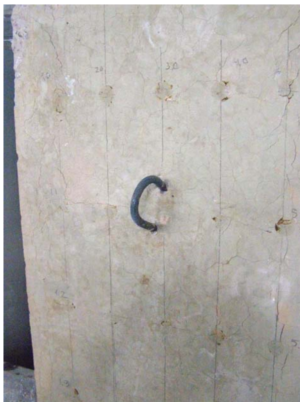
Рис. 3.15. Вигляд зразка колони після випробувань
