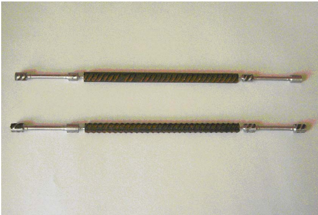
Рис. 3.2. Вигляд виготовлених зразків для досліджень при підвищених температурах
