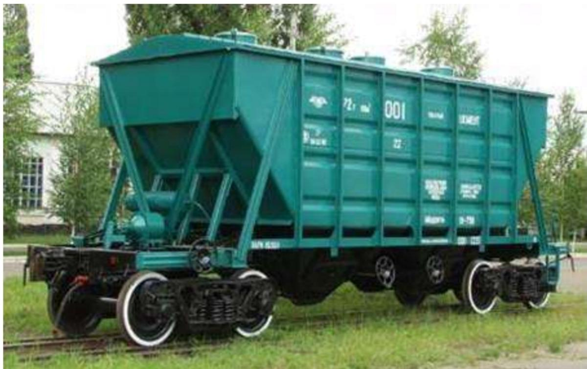
Рисунок 1.4 – Загальний вигляд вагона-хопера моделі 19-758 для перевезення цементу
