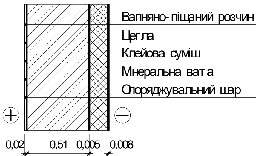
Рис. 1. Перетин зовнішньої стіни
