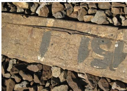
Рис. 4. Основні дефекти (пошкодження) шпал
