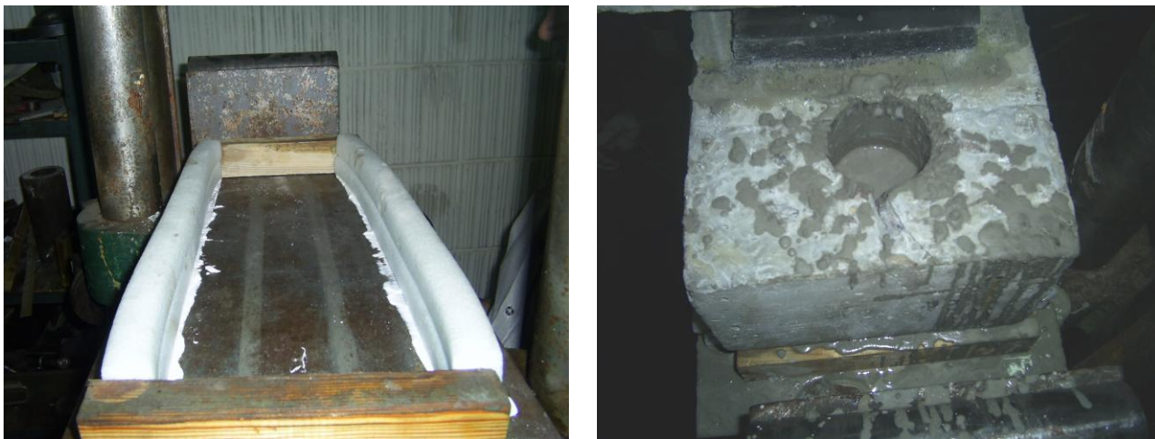
Рис. 2.1 Дослідження розтікання суміші полімерцементного композиту в моделі зазору між плитою БМП і балкою мосту: а - модель зазору до встановлення плити; б - заливання суміші у зазор через отвір у плиті
