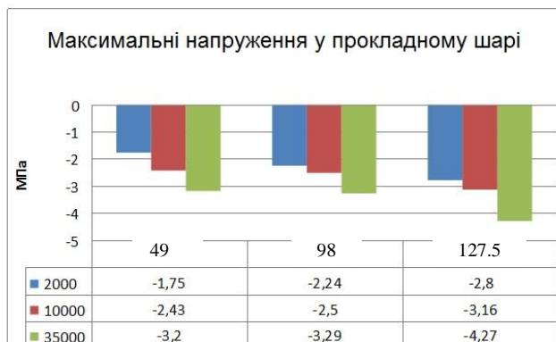
Рис. 3.4 Максимальні величини напружень і деформацій в плиті БМП при модулі деформації (пружності) прокладного шару та сили затягування шпильок
