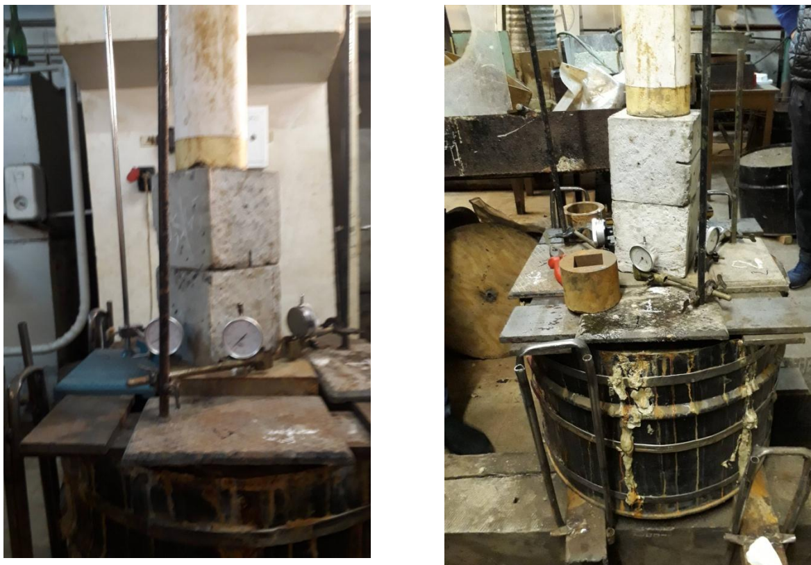
Рис. 2.12 Фіксація деформацій ґрунту в моделі за допомогою індикаторів ІЧ-10
