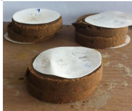
Рис. 2.7 Випробування зразків методом одноплщинного зрізу (а, б) та зразки після випробування (в, г)
