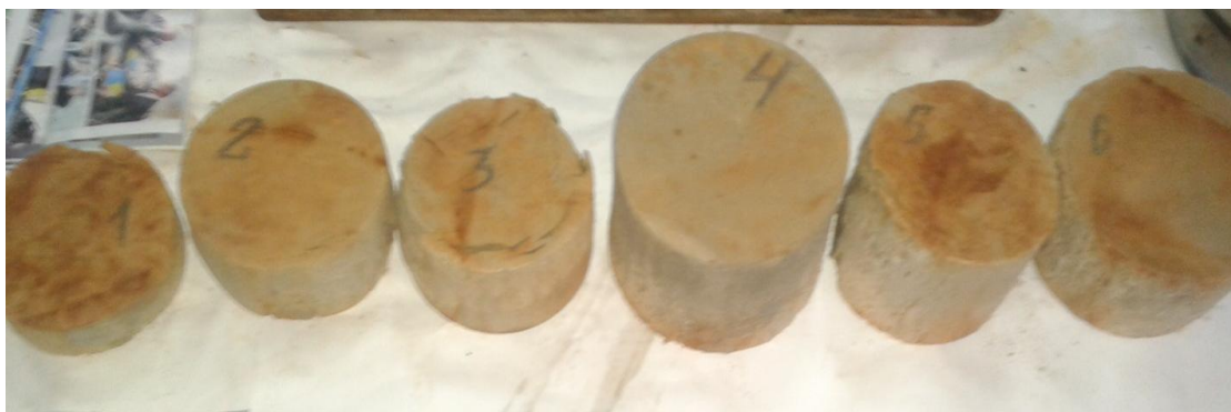
Рис. 4.36 Зразки без ґрунту після 10 циклів випробувань на стійкість до попереминого зволоження та висушування
