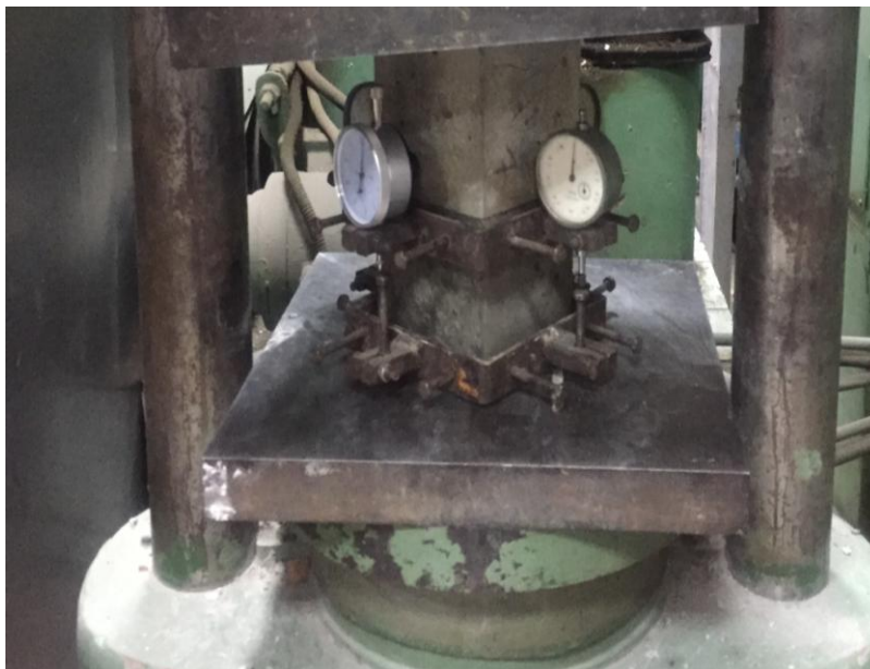
Рис. 2.5 Дослідження деформативності прокладного шару за удосконаленою методикою за допомогою гідравлічного преса та індикаторів годинникового типу
