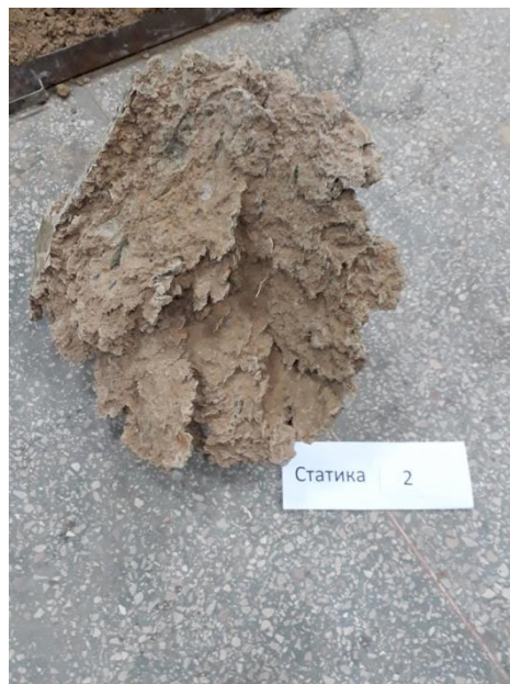
Рис. 4.23 Матеріал із моделі №2 для статичних випробувань
