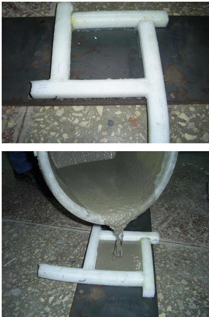
Рис. 2.2 Виготовлення прокладного шару моделі вузла сполучення верхньої полиці подовжньої балки, прокладного шару товщиною 2,5 см і плити БМП
