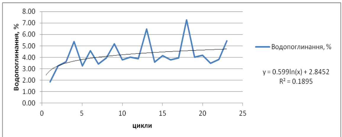
Рис. Б.10 Залежність від кількості циклів попереминого зволоження – ви-сушування зразка 34 (закріпленого матеріалом SPT ® ґрунту): а – залишку (оста-точної ваги), %; б – втрати маси, %; в – водопоглинання за масою, %
