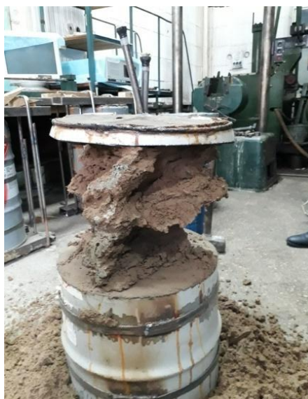
Рис. 4.25 Розділення моделей на фрагменти (для моделі 1 використовувалася для випробувань лише нижня частина)
