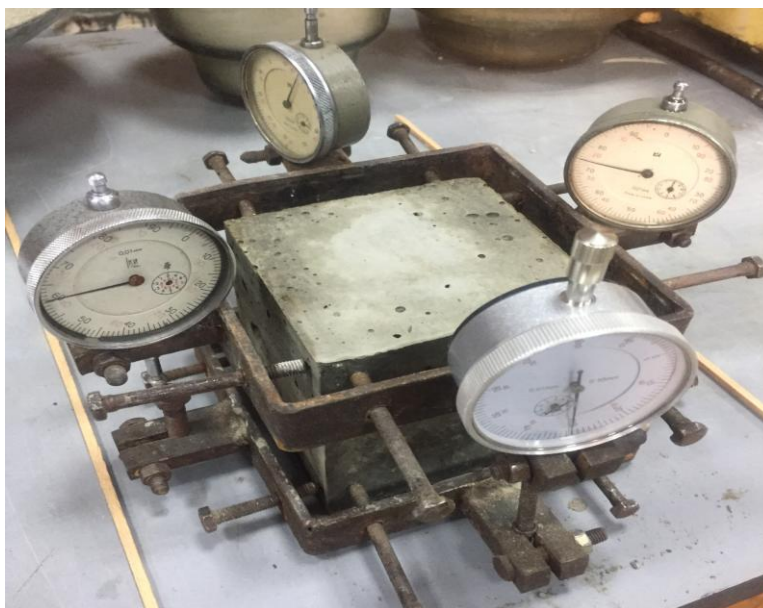
Рис. 2.3 Збирання моделі вузла сполучення верхньої полиці подовжньої балки, прокладного шару товщиною 2,5 см і плити БМП та дослідження деформативності прокладного шару за допомогою гідравлічного преса та індикаторів годинникового типу
