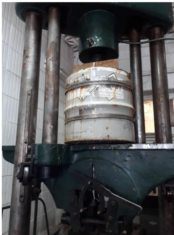
Рис. 2.13 Випробування моделі ґрунтополімерної композиції динамічним навантаженням
