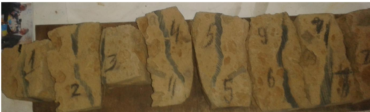
Рис. 2.15 Зразки з ґрунтом після 12 циклів випробувань на стійкість до перемінного зволоження та висушування
