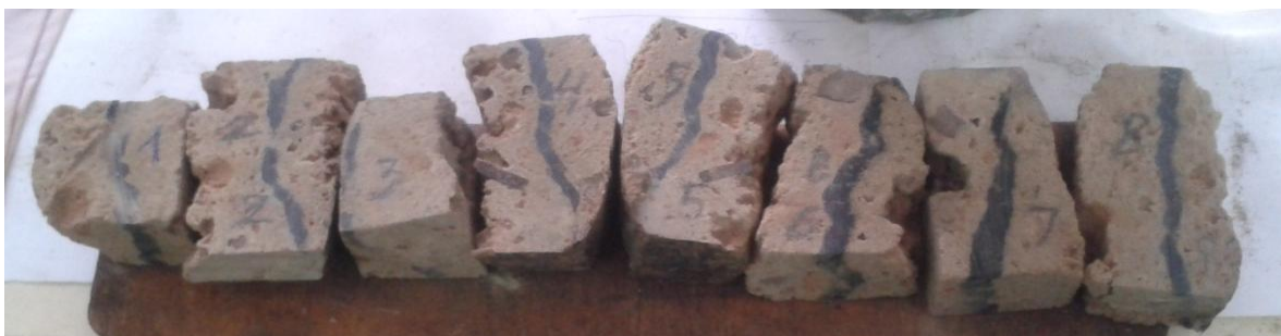
Рис. 2.14 Зразки з ґрунтом до випробувань на стійкість до перемінного зволоження та висушування
