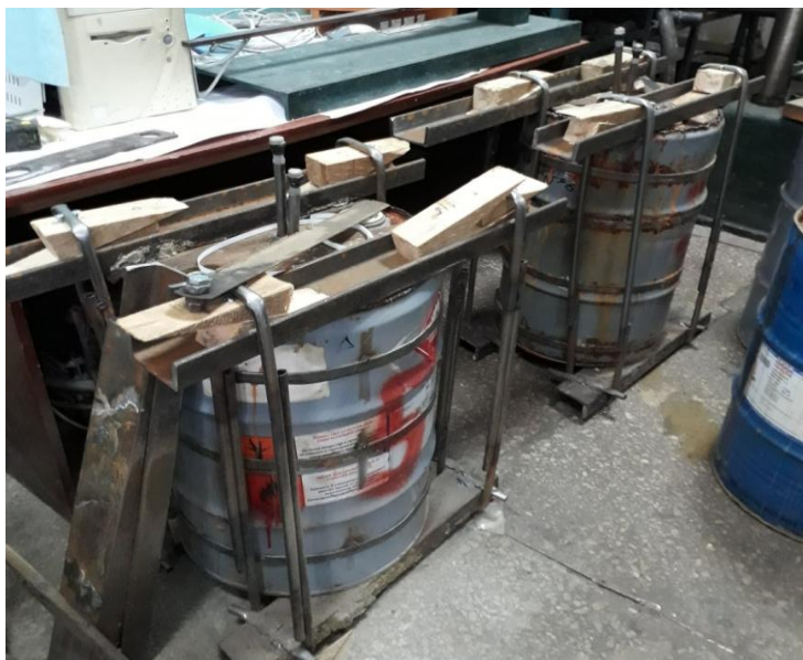
Рис. 2.9 Модель із закріпленням ґрунтом для динамічних випробувань
