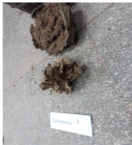
Рис. 4.35 Матеріал із моделі №3 для динамічних випробувань
