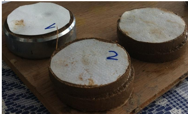
Рис. 2.7 Випробування зразків методом одноплщинного зрізу (а, б) та зразки після випробування (в, г)
