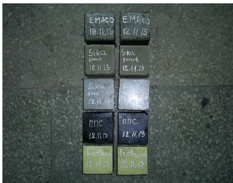
Рис. 2.4 Зразки-куби з розміром ребра 10 см для дослідження деформативності прокладного шару за удосконаленою методикою
