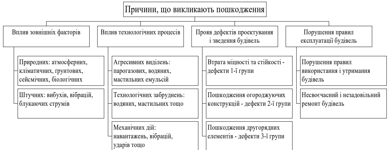
Рис. 1.3. Причини пошкоджень будівель
