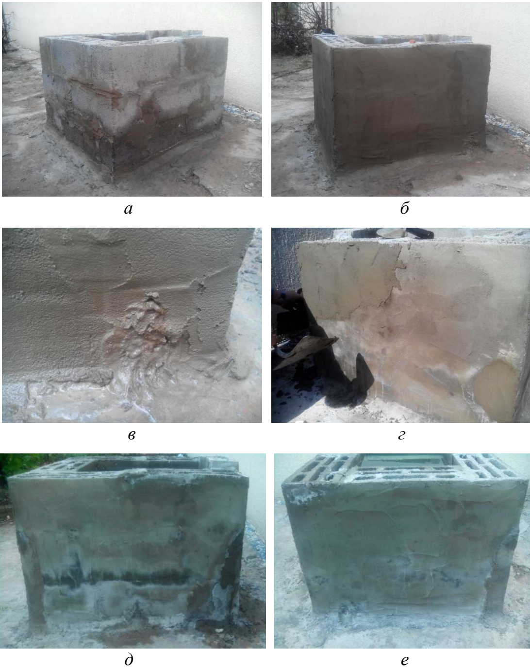
Рис. 5.4. Експериментальні дослідження ефективності гідроізоляційної композиції проникної дії: a – наповнений водою бетонний короб; б – нанесена на зовнішню поверхню короба гідроізоляційна силікатна композиція (одразу після нанесення); в – місце активної течії крізь гідроізоляційне покриття; г – другий шар композиції, що нанесений через 1 добу після нанесення першого шару; д – поверхня коробу через 4 доби після нанесення першого шару гідроізоляційної композиції; е – поверхня коробу через 6 діб після нанесення першого шару гідроізоляційної композиції
