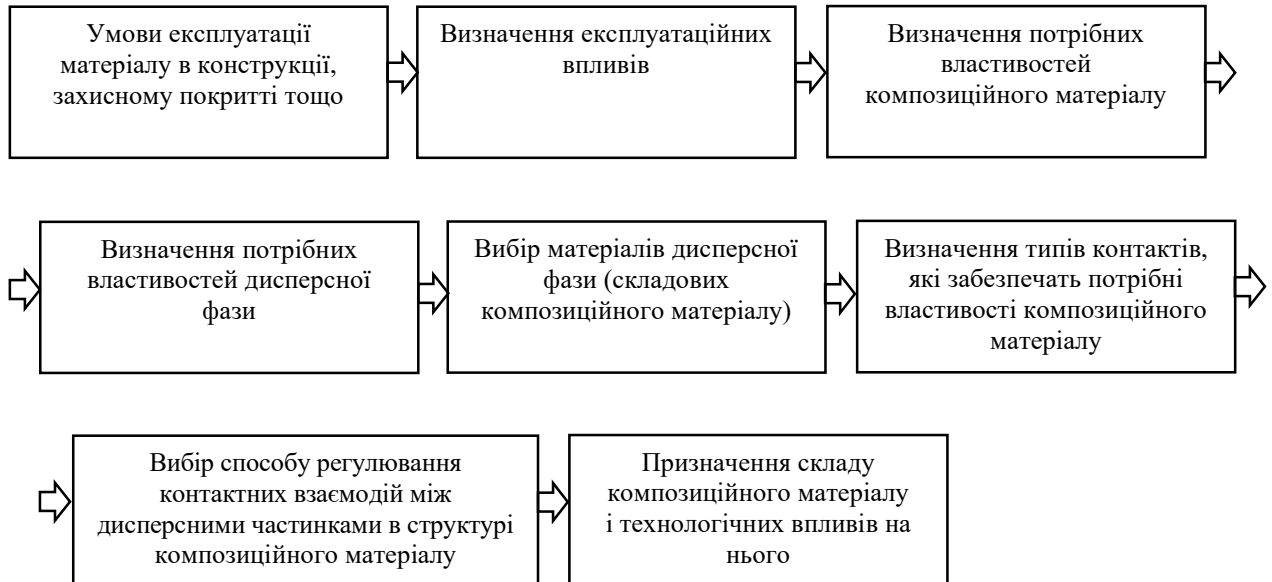
Рис. 4.28. Алгоритм регулювання контактних взаємодій в композиційних матеріалах на основі мінеральних в'язучих для забезпечення їх стійкості в умовах експлуатації
