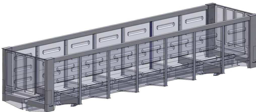
Рисунок 3.3 – Просторова модель несучої конструкції напіввагону з піноалюмінієм у якості наповнювача його складових
