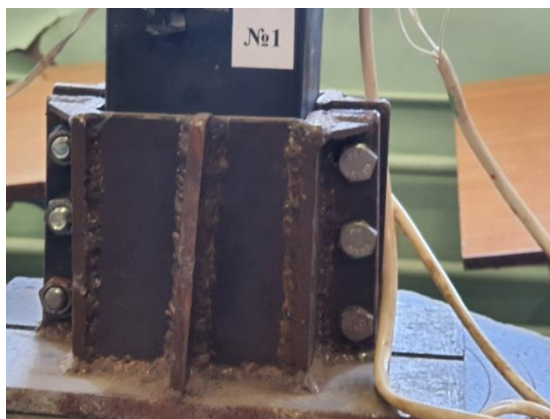
Рисунок 5.5 – Закріплення кінцевої частини елемента у стакані
