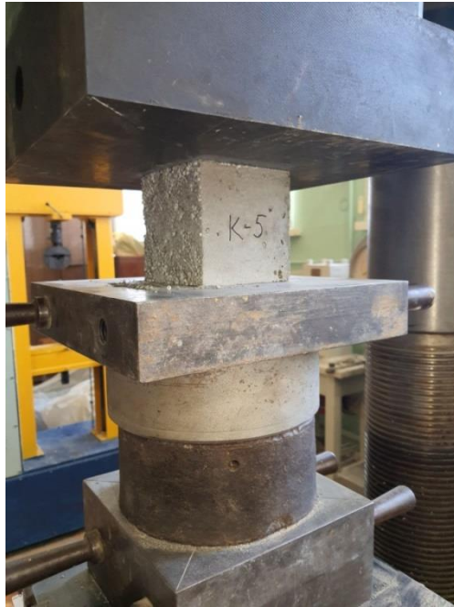
Рисунок 5.14 – Розміщення дослідного зразка на пресі
