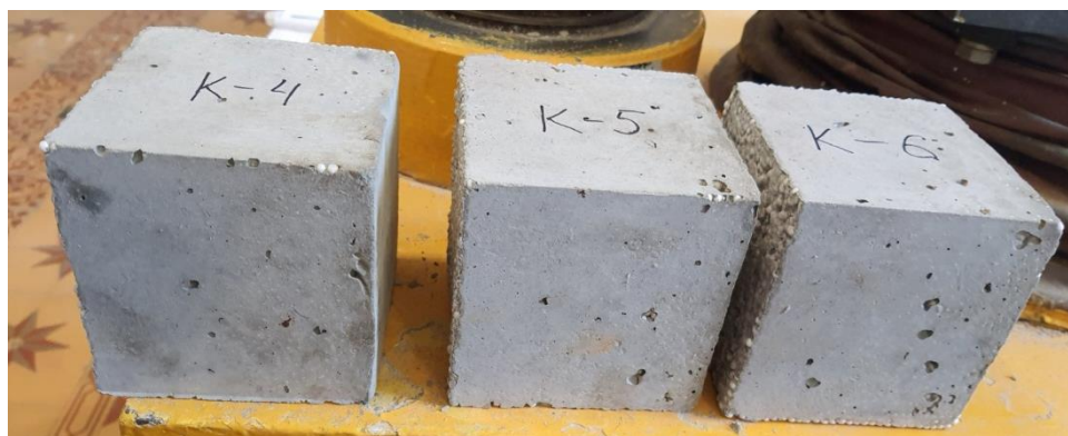
Рисунок 5.13 – Дослідні зразки для визначення міцності наповнювача
