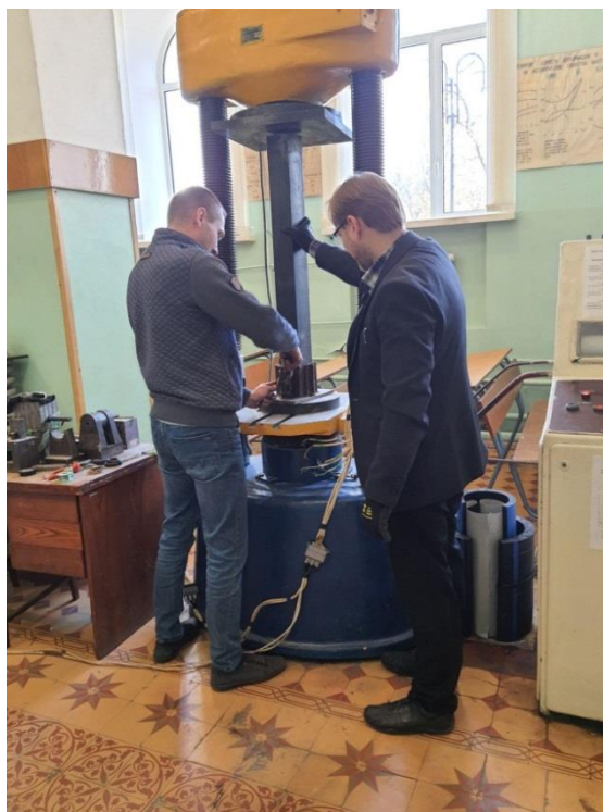
Рисунок 5.20 – Встановлення дослідного зразка на прес
