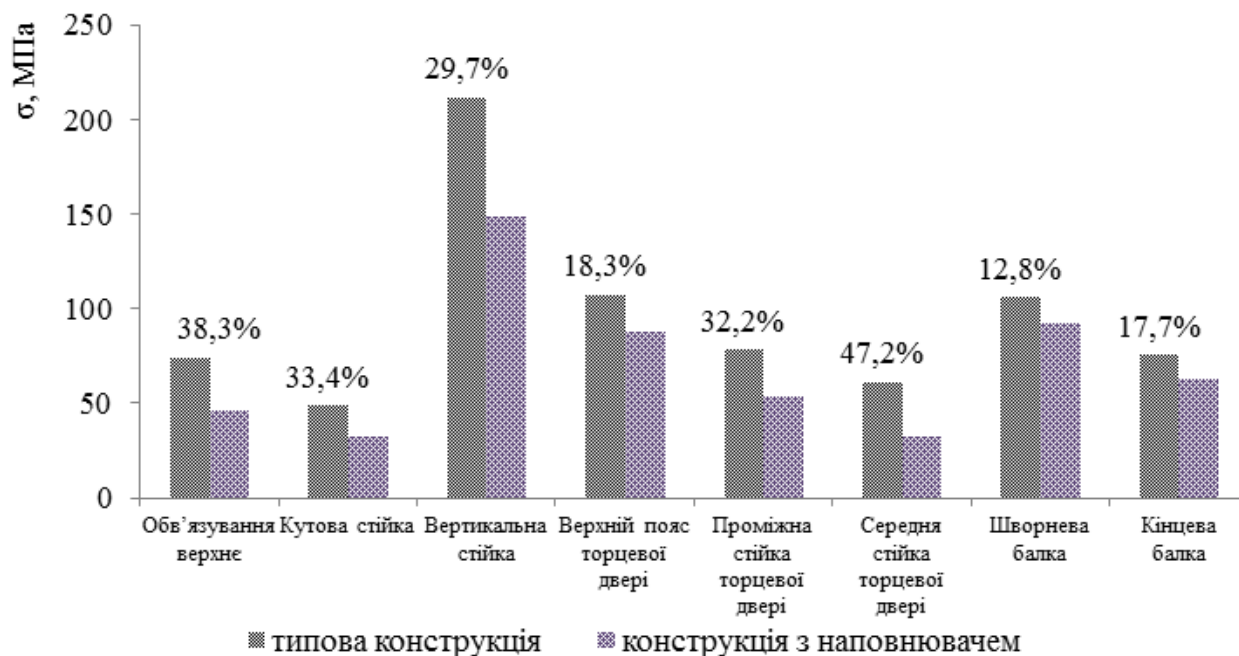
Рисунок 3.8 – Розбіжність між максимальними еквівалентними напруженнями в типовій несучій конструкції напіввагона та з урахуванням використання наповнювача
