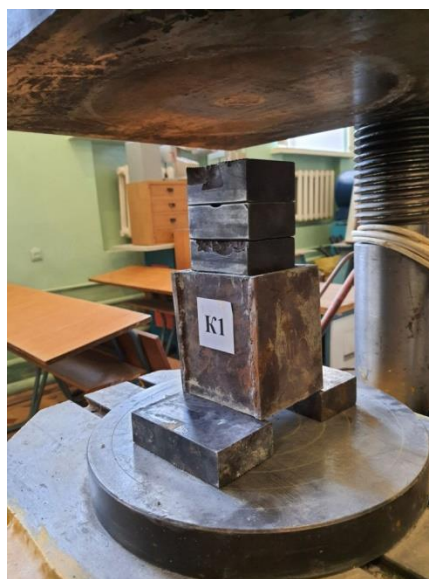
Рисунок 5.16 – Розміщення дослідного зразка на пресі
