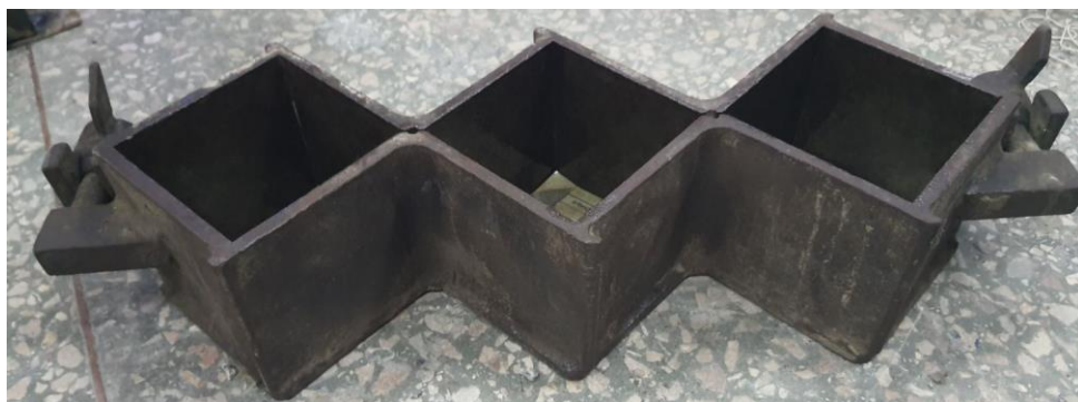
Рисунок 5.12 – Металеві форми для створення дослідних зразків
