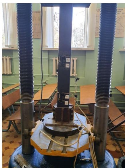
Рисунок 5.6 – Розміщення елемента в пресі
