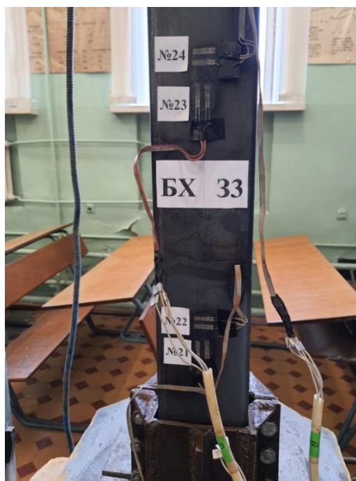
Рисунок 5.21 – Розміщення тензорезисторів на дослідному зразку з наповнювачем
