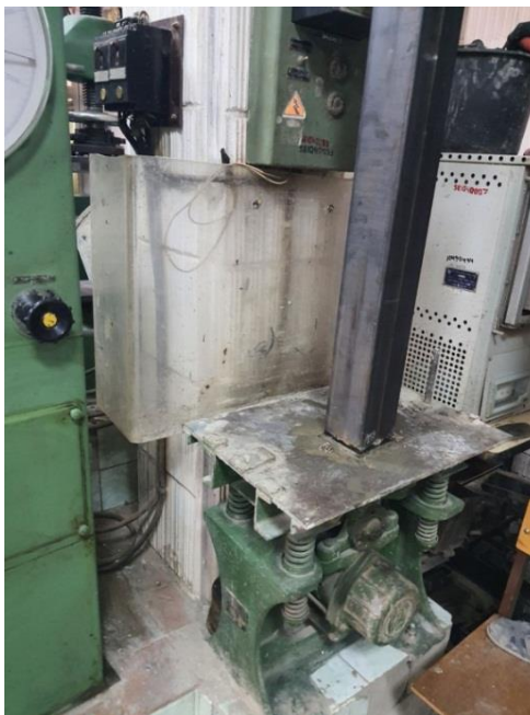
Рисунок 5.18 – Розміщення зразка з наповнювачем на вібраційному стенді
