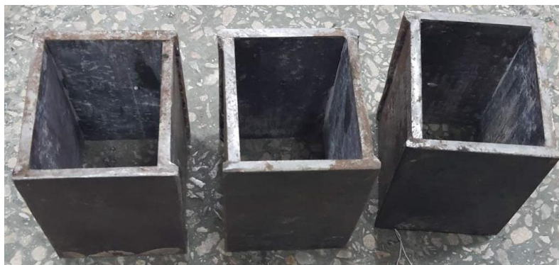
Рисунок 5.15 – Форми для створення дослідних зразків
