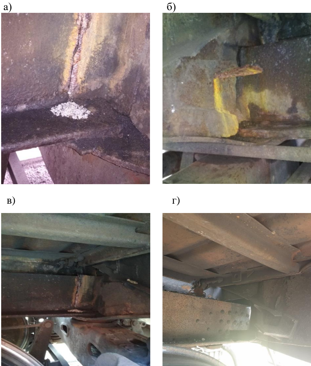
Рисунок 1.4 – Пошкодження рами вагона
