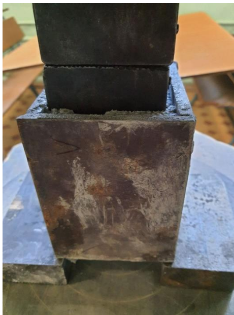
Рисунок 5.17 – Передача стискаючого зусилля на наповнювач
