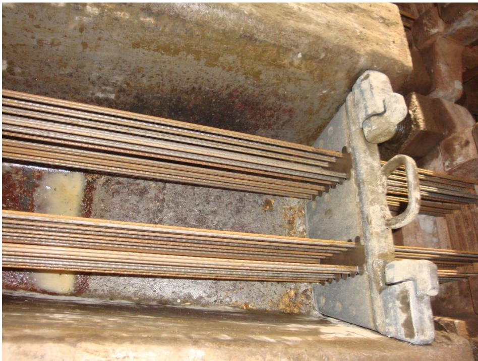
Рис. 1.2 Технологія виробництва залізобетонних шпал: а – 10-місні силові форми; б – на тяжіння арматурного дроту і встановлення діафрагм
