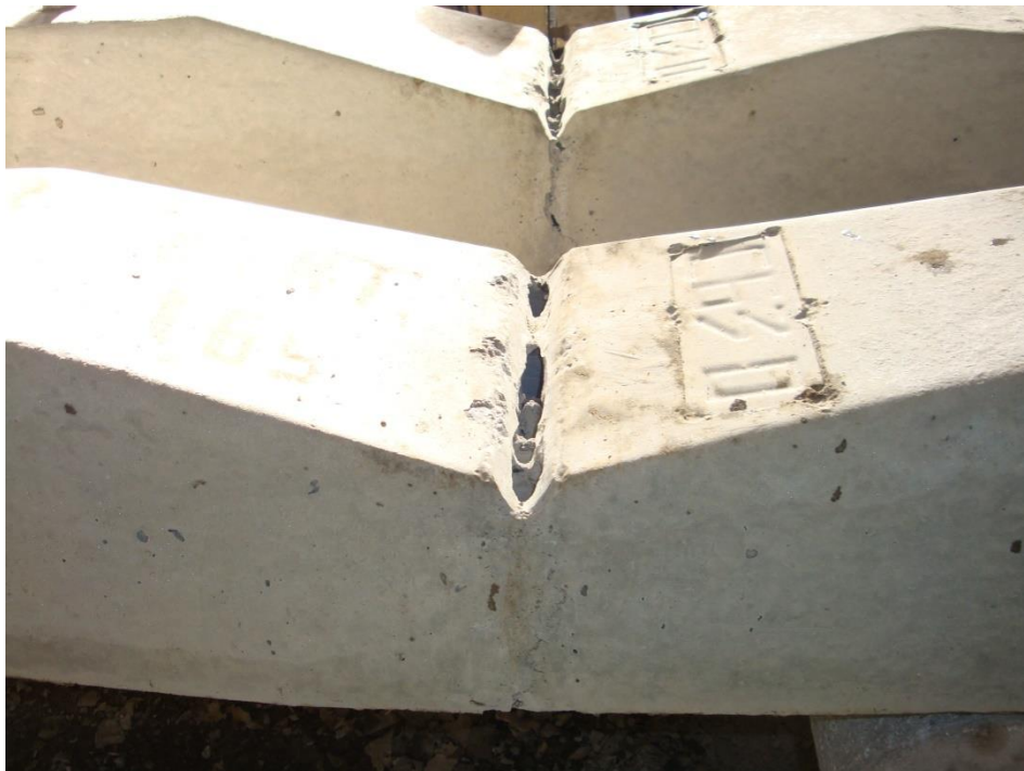
Рис. 1.4 Технологія виробництва залізобетонних шпал: а – зазор між торцями шпал після негайного розпалублення (видалення діафрагм); б – запливання бетонною сумішшю зазору між торцями послідовно суміжних шпал
