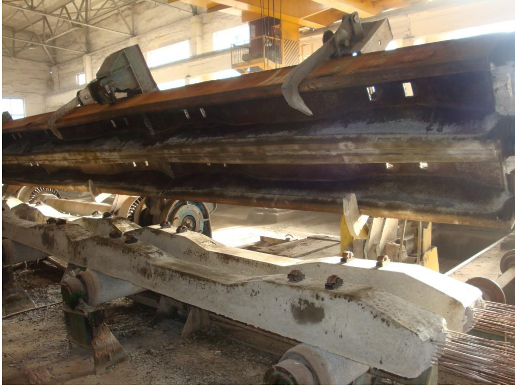
Рис. 1.5 Технологія виробництва залізобетонних шпал: а – тепловологісна обробка в камері ТВО; б – розпалублення шпал кантувателем
