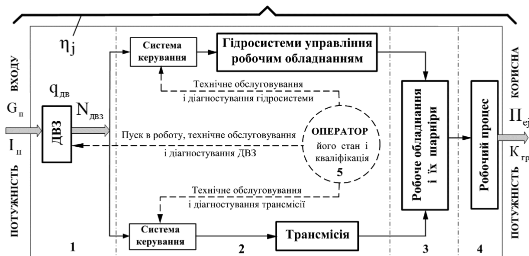
Рис. 1. Структурна схема одноковшового навантажувача
