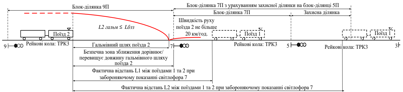
Рис. 1. Забезпечення безпечної зони зближення між попутно прямуючими суміжними поїздами на перегонах при АБ з фіксованими блок-ділянками
