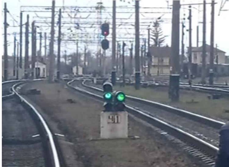
Рис. 8. Випробовування макету на світлофорі (ліворуч зелений вогонь з лампою розжарювання, праворуч – світлодіодний макет)
