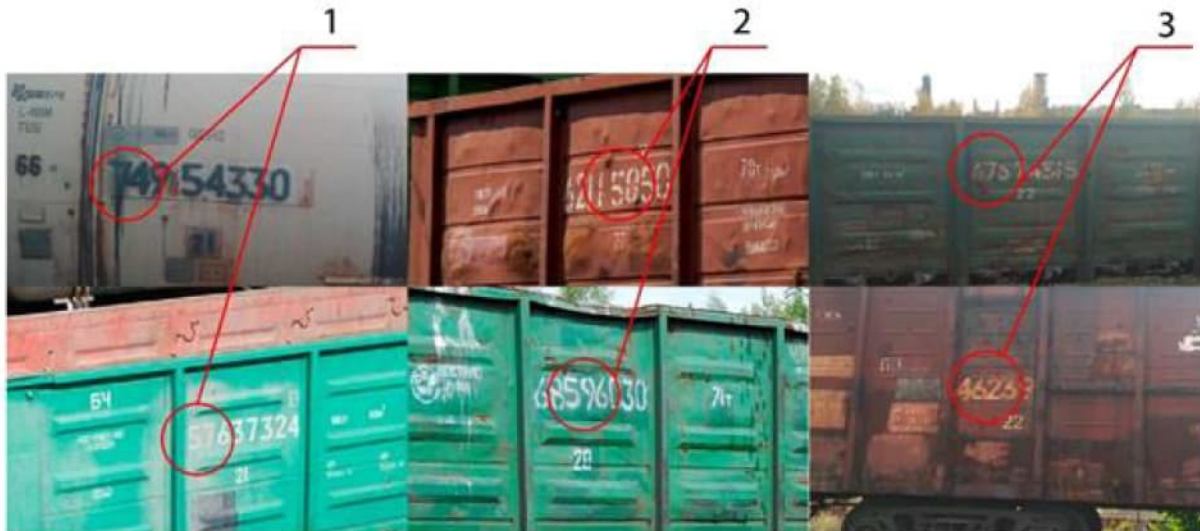
1 – забруднення від вантажу; 2 – деформація обшивки кузова; 3 – корозія металу
