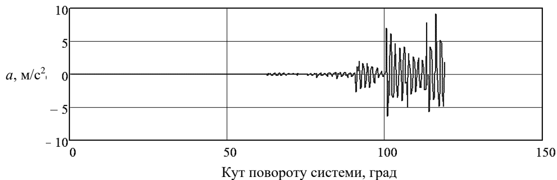
Рис. 4. Характер прискорень кузова ПВ при перекиданні
