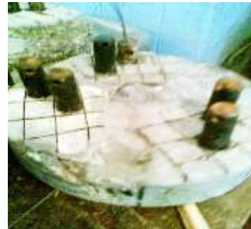
Рис. 6. Зразки-диски з наклеєними металевими грибками
