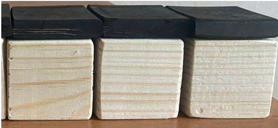
Рис. 7. Зразки гумодерев'яного прокладного шару
