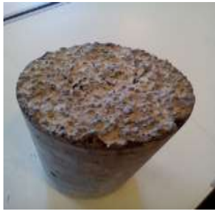
Рис. 4. Зразок керна з зернистою поверхнею
