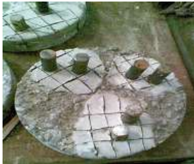
Рис. 6. Зразки-диски з наклеєними металевими грибками
