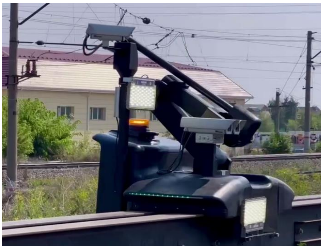
Рис. Б.2. Роботизована технологія розчеплення вантажних вагонів від компанії Rail Cargo Group (Австрія)
