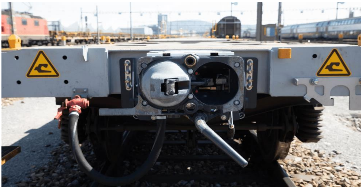
Рис. Б.1. Технологія цифрового роботизованого зчеплення вантажних вагонів компанії Deutsche Bahn (Німеччина)
