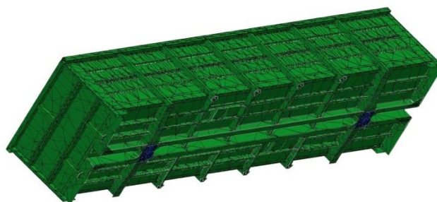
Рис. 2. Сінчено-елементна модель кузова напіввагона моделі 12-7023
