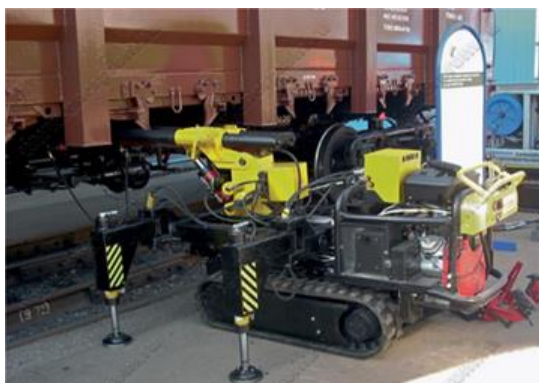
Рис. 1. Мобільна установка правки та заміни люків напіввагонів
