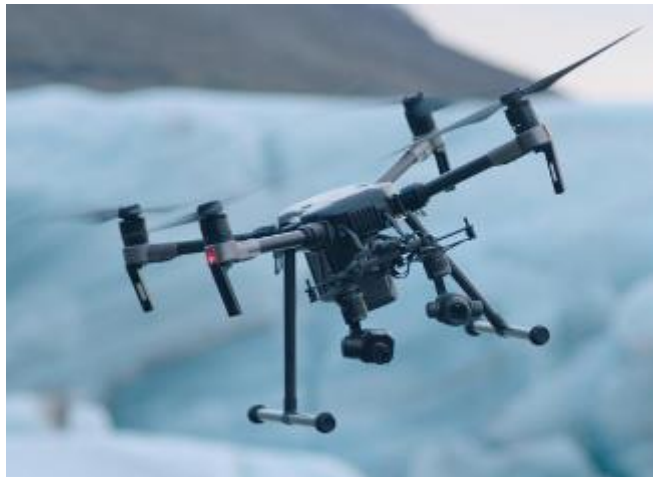
Рис. 1 – БПЛА з 30-ти кратним збільшенням
