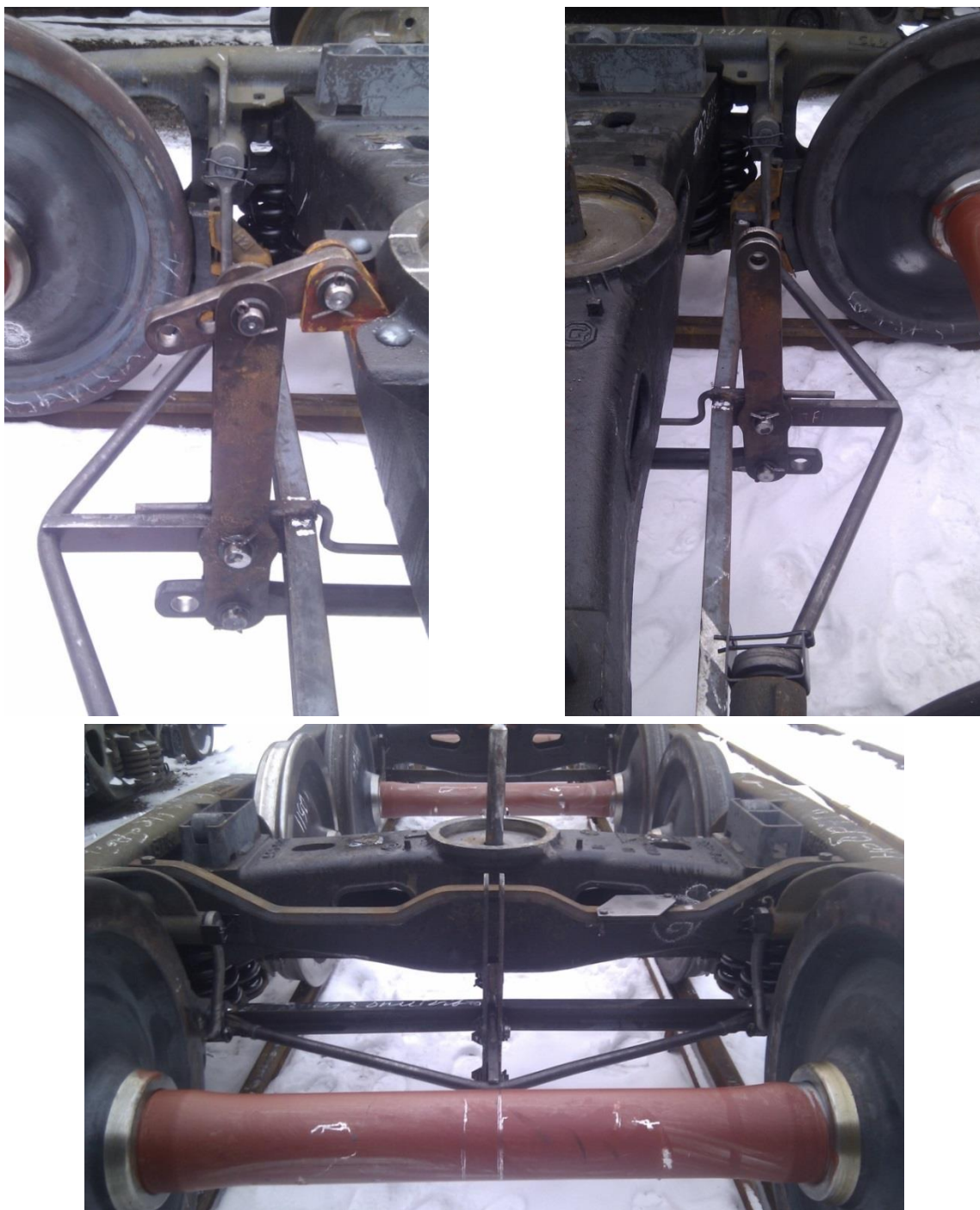
Рисунок Д.1 – Візки з модернізованою ГВП, підготовлені для підкочування під дослідні вагони
