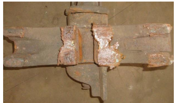
Рисунок 1.4 – Несправності механічної системи гальмового обладнання візків вантажних вагонів
