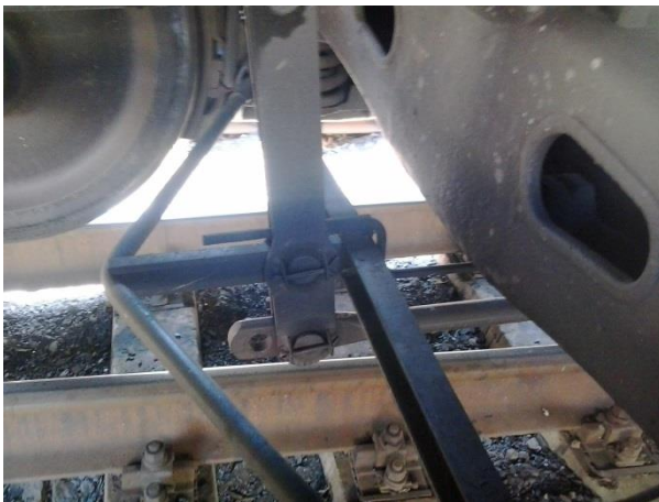
Рисунок Д.3 – Модернізований пристрій ГВП на вагоні під час утримання КГК на нормативній відстані відносно поверхні кочення коліс:
