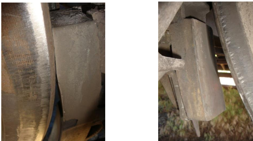
Рисунок 2.4 – Клинодувальний знос КГК в експлуатації під час попущених гальм
