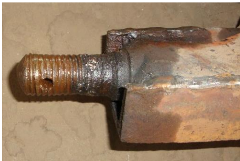
Рисунок 1.4 – Несправності механічної системи гальмового обладнання візків вантажних вагонів
