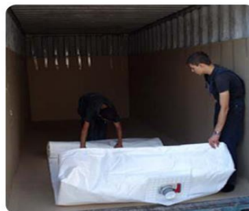
Рис. 3. Підготовка контейнера та укладання флексітанка в контейнер
