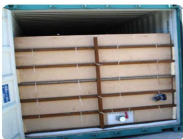
Рис. 5. Встановлення щита та завантаження флексітанка через заливний шланг
