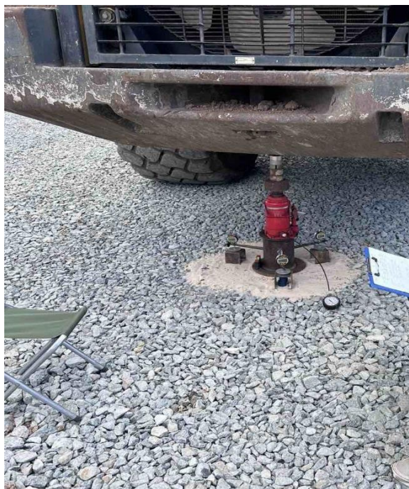
Рис. Штампові випробування подушки товщиною 30 см
