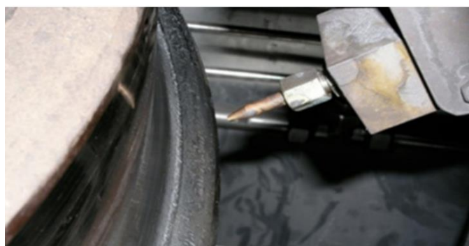
Рис. 7. Насадка для фланця колеса TrainSys-AL
