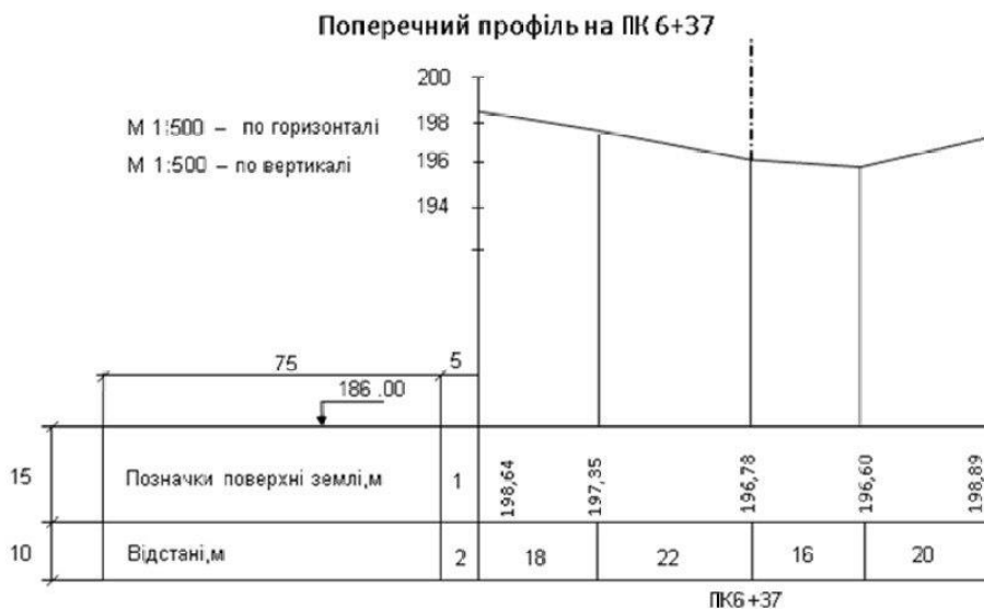
Рис. 4. Зразок оформлення поперечного профілю
