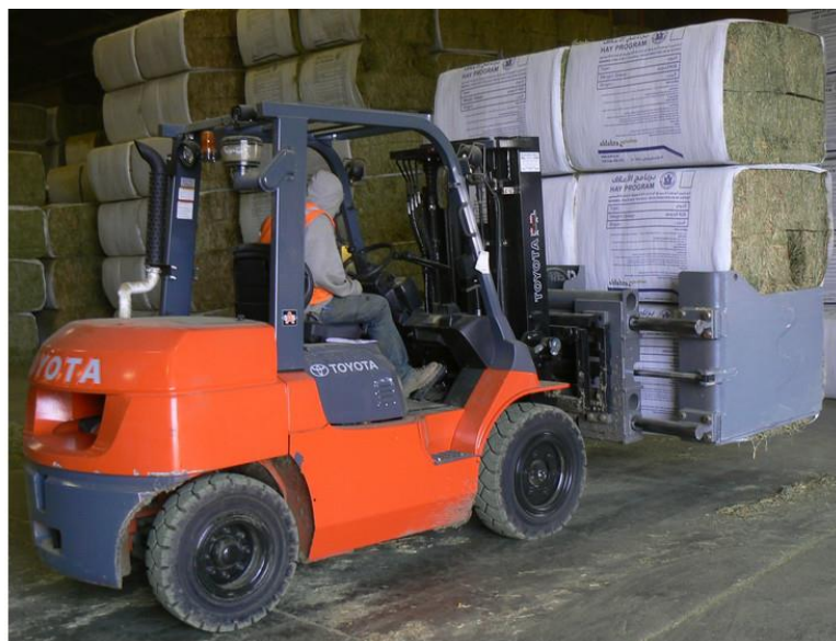
Рис. 2. Захоплювачі для кіп із бічними затискачами
