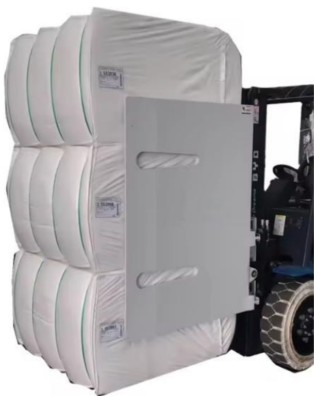
Рис. 2. Захоплювачі для кіп із бічними затискачами
