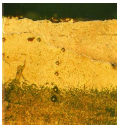
Рис. 5. Зміна мікротвердості по перерізу зразка після ТФЗ за режимом оброблення поверхні № 2 (Сталь 65Г, х250)
