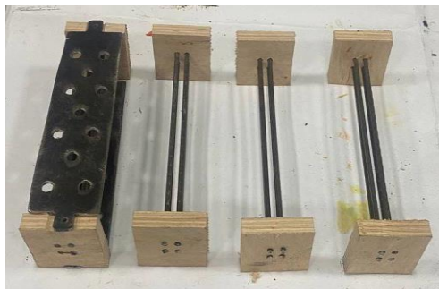
Рис. 2. Фіксація арматури та накладних електродів у формах
