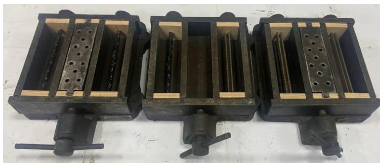
Рис. 2. Фіксація арматури та накладних електродів у формах
