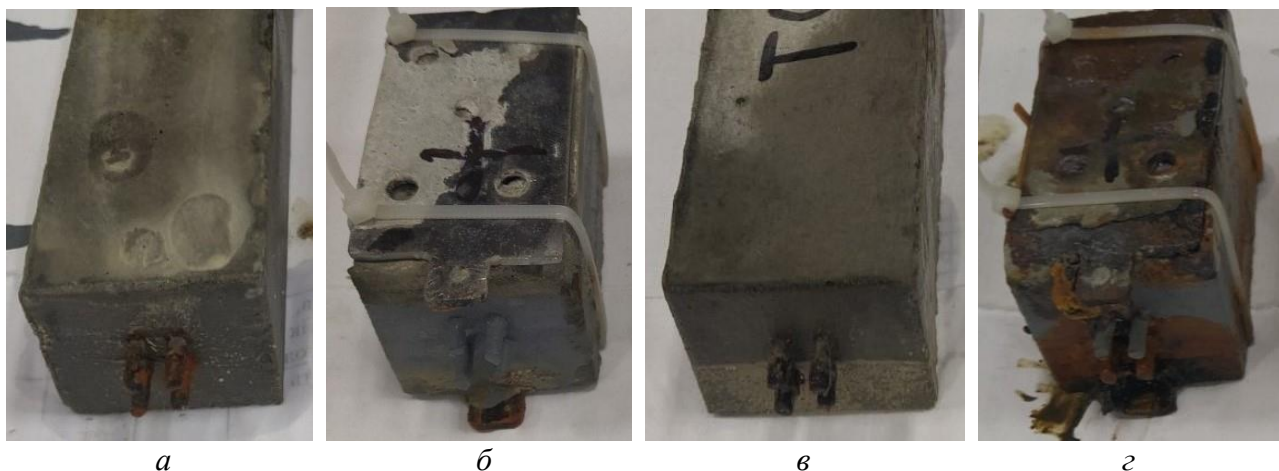
Рис. 6. Моделі після експозиції: а, б – у водному середовищі без електричного впливу ( а ) і під впливом ПОЕП ( б ); в, г – у розчині хлориду натрію без електричного впливу ( в ) і під впливом ПОЕП ( г )
