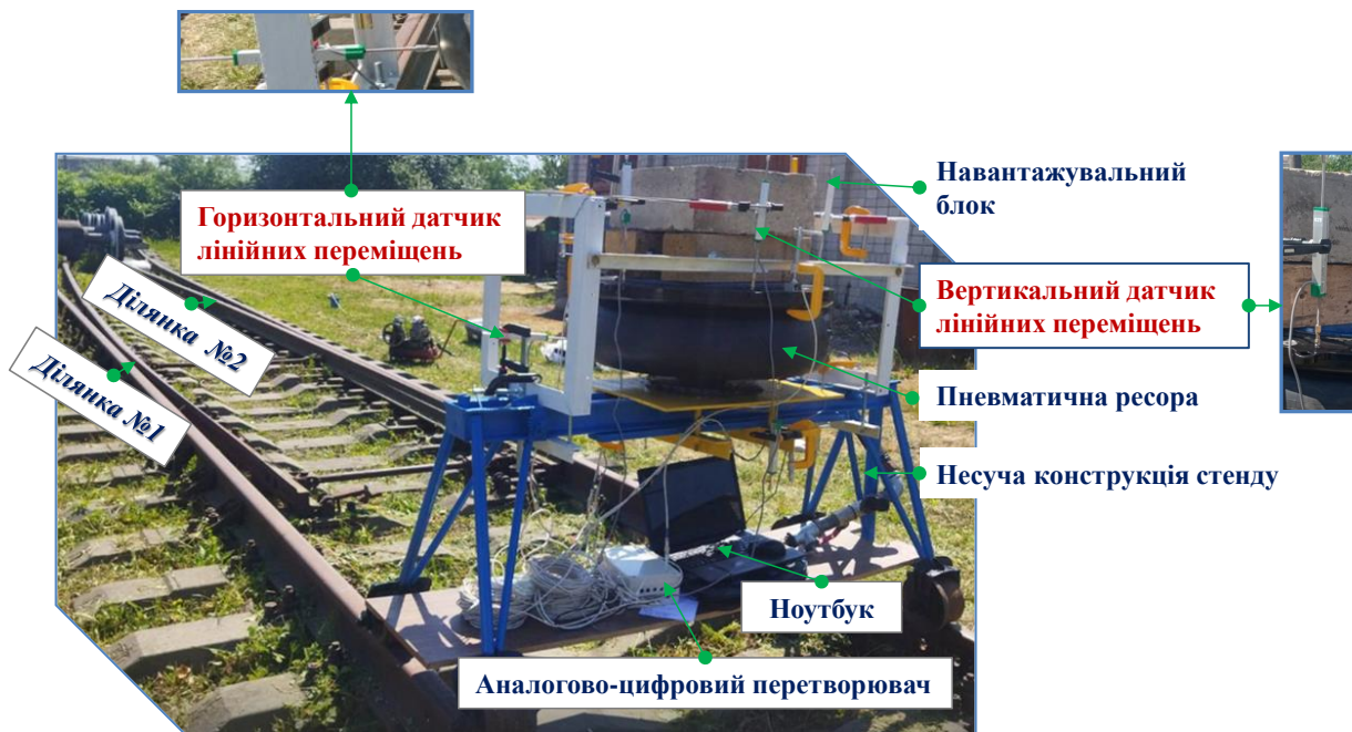
Рис. 2. Випробувальна установка пневматичної ресори швидкісного рухомого складу
