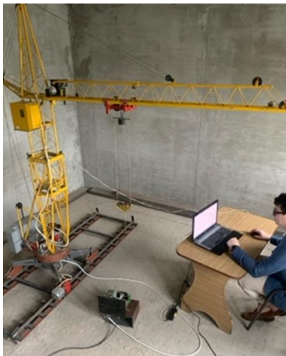
Рис. 8. Модель баштового крана КБ-403А (масштаб 1:20)
