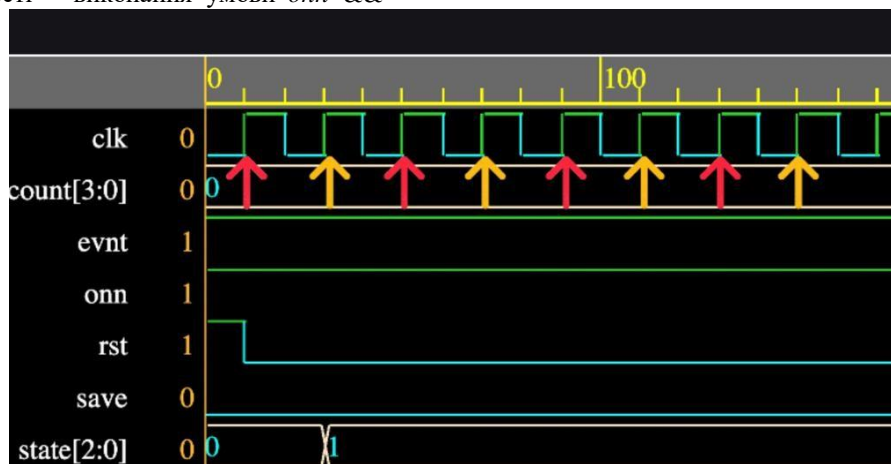
Рис. 11. Часова діаграма роботи автомата, коли зовнішня подія не відбувається
