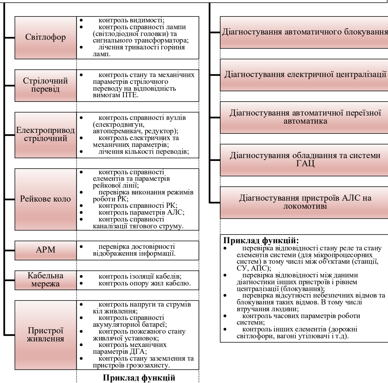
Рис. 8. Схема розподілу елементів діагностування
