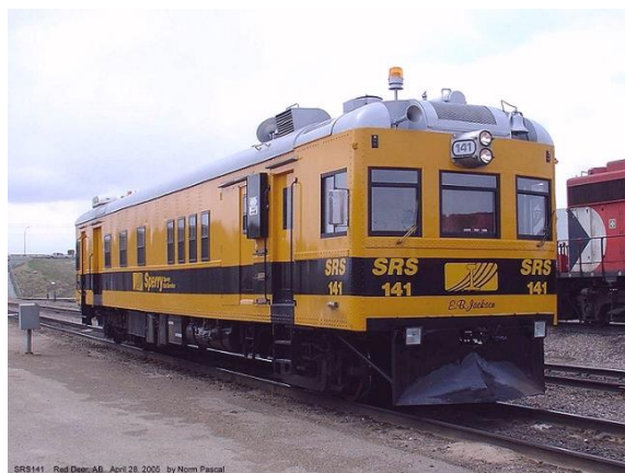
Рис. 2. Огляд залізничної колії з використанням автоматизованої візуально-виміральної системи [7]
