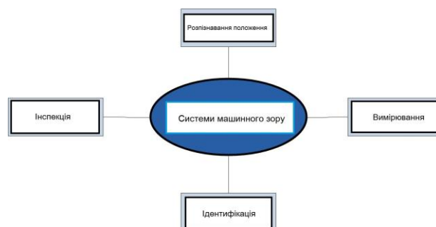
Рис. 10. Завдання, які розв'язуються системами машинного зору [14-16]
