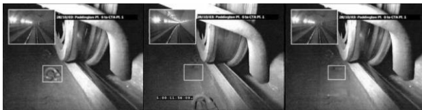
Рис. 12. Автоматизований відеоаналіз отриманих серій зображень залізничної колії та рухомого складу вагона [17]
