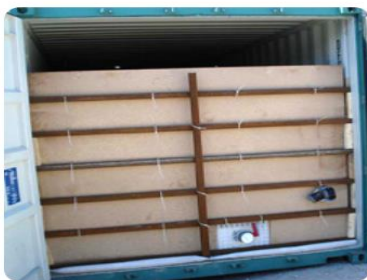
Рис. 5. Встановлення щита та завантаження флексітанка через заливний шланг
