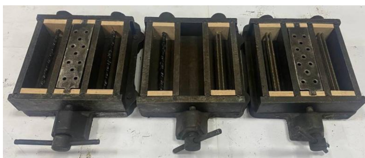
Рис. 2. Фіксація арматури та накладних електродів у формах
