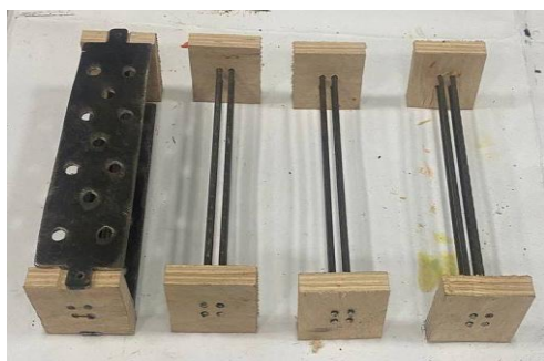
Рис. 2. Фіксація арматури та накладних електродів у формах
