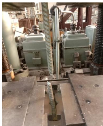
Рис. 2. Арматура після випробування
