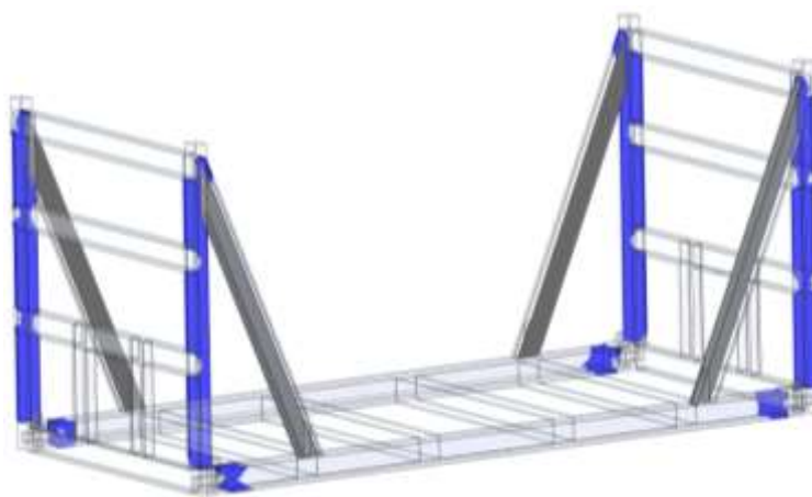
Рисунок 3.52 – Найбільш навантажені зони знімного модуля при його підйомі спредером
