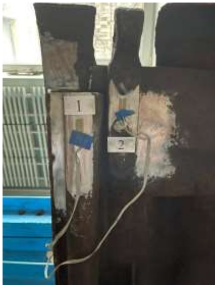
Рисунок 4.4 – Розміщення тензорезисторів на кришці люка (нижня частина полотна)
