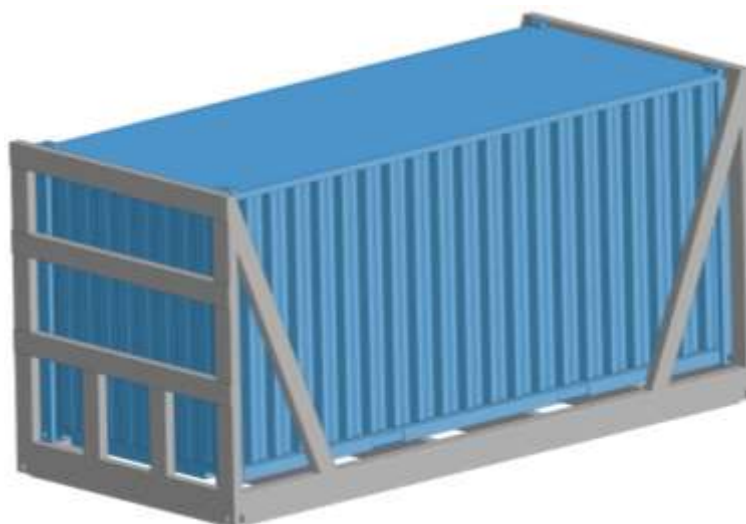
Рисунок 3.2 – Розміщення контейнера в модулі
