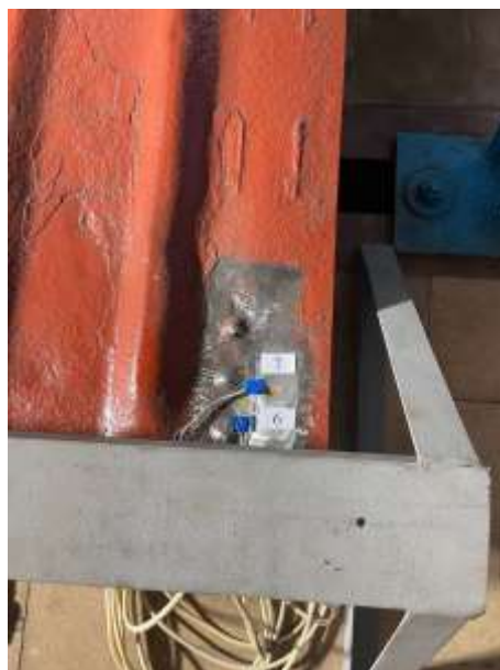
Рисунок 4.5 – Розміщення тензорезистора на кришці люка (верхня частина полотна)
