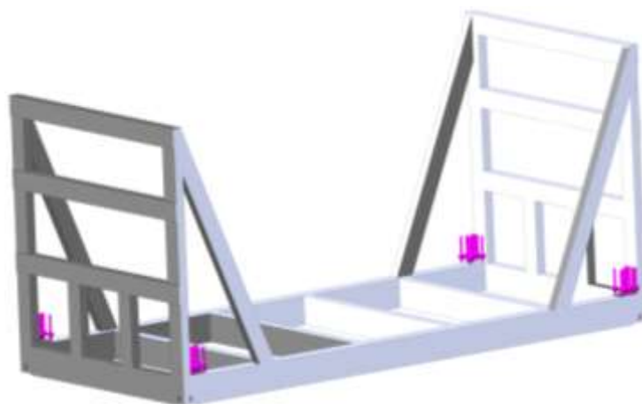
Рисунок 3.30 – Розрахункова схема знімного модуля при сприйнятті ним вертикальних навантажень
