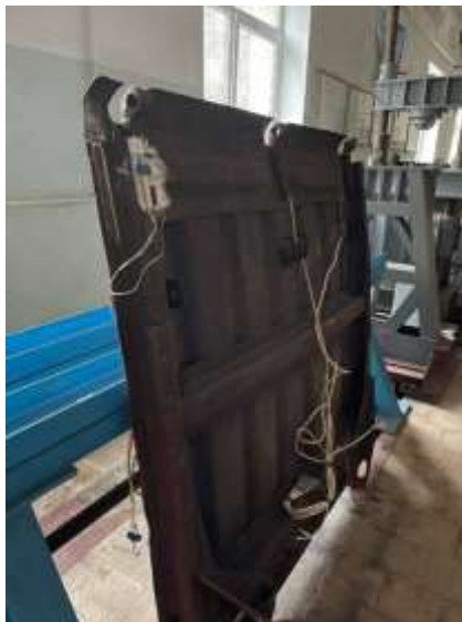
Рисунок 4.4 – Розміщення тензорезисторів на кришці люка (нижня частина полотна)
