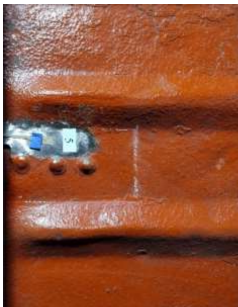
Рисунок 4.5 – Розміщення тензорезистора на кришці люка (верхня частина полотна)
