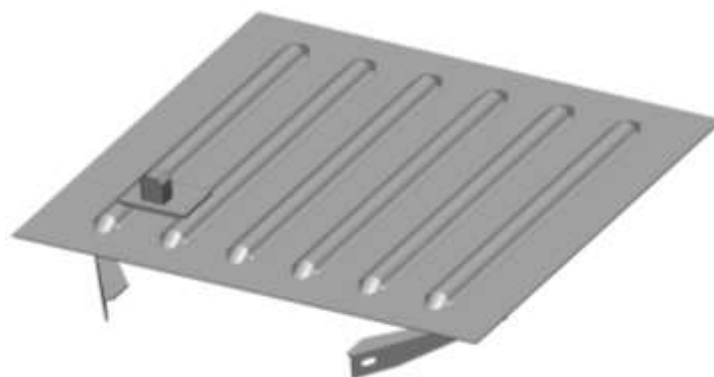
Рисунок 2.22 – Просторова модель кришки люка з фітинговим упором
