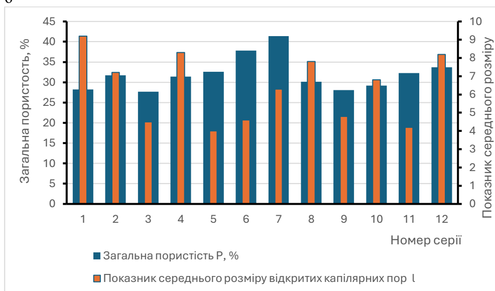
Рис. 2. Значення закритої, відкритої (а) і загальної пористості і показника середнього розміру відкритих капілярних пор \bar{l} (б) для серій зразків
