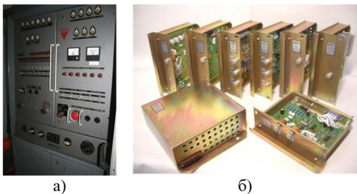
Рис. 2. Пульт керування (а) та електронні блоки (б) пасажирського вагона
