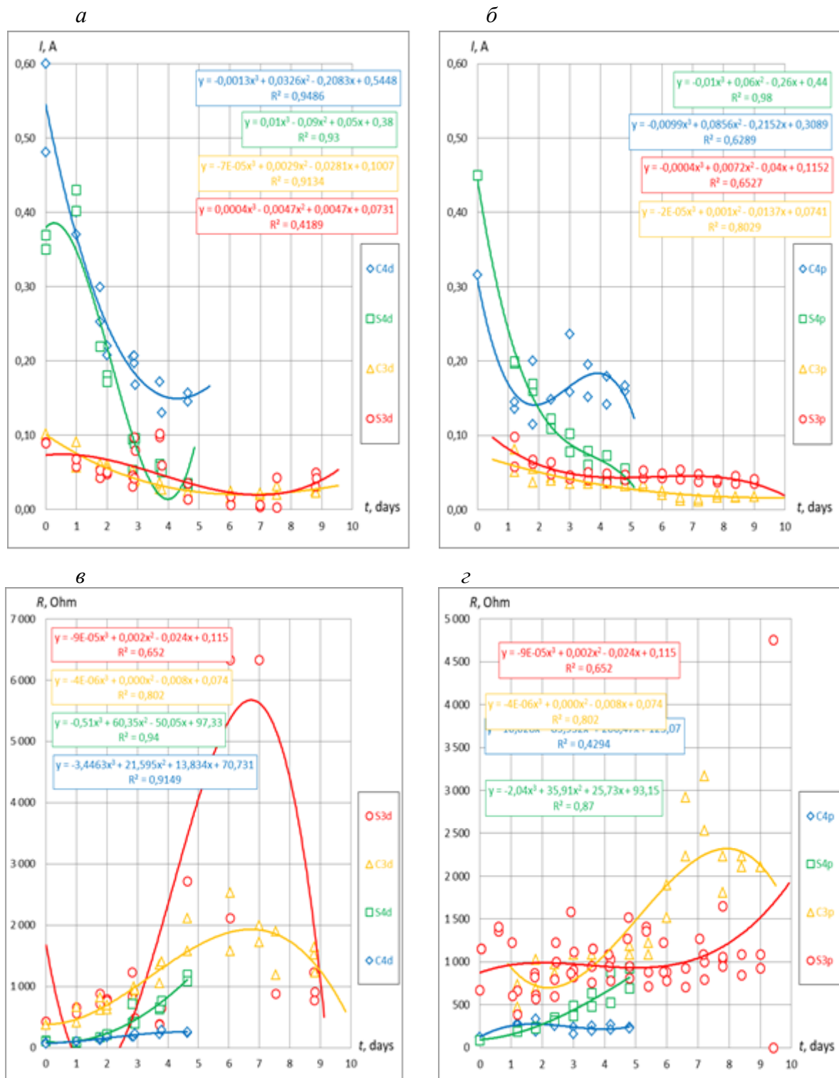
Рис. 5. Зміна в часі впродовж впливу постійного та пульсуючого (у перерахунку на тривалість безпосереднього електричного впливу) електричного потенціалу: а – сили струму у зразках S3d, C3d, S4d, C4d; б – те саме у зразках S3p, C3p, S4p, C4p; в – електричного опору зразків S3d, C3d, S4d, C4d; з – те саме зразків S3p, C3p, S4p, C4p
