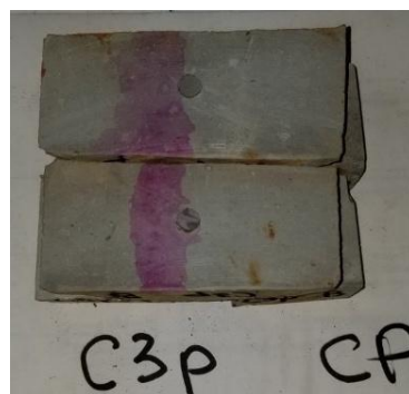
Рис. 7. Поверхня зрізів зразків C3p після експозиції за агресивних і електричних впливів, оброблена розчином фенолфталеїну (таке саме забарвлення на всю товщину спостерігали на зрізах усіх зразків)
