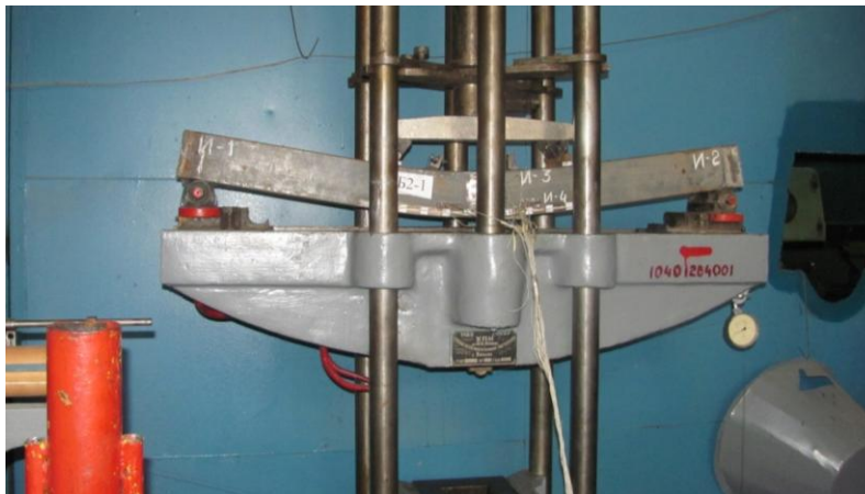
Рис. 5. Згинальний елемент трубобетону після випробування
