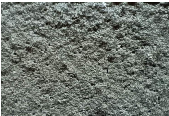
Рис. 3. Фото перерізів зразків із заміною 40 % піску ( а ) і 10 % цементу ( б )
