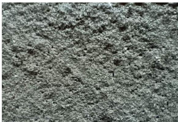
Рис. 3. Фото перерізів зразків із заміною 40 % піску (а) і 10 % цементу (б)
