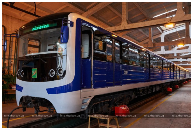
Рис. 7. Електропоїзд серії ЕЖ 3 після капітально-відновлювального ремонту
