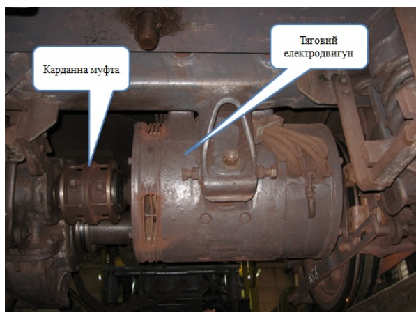
Рис. 4. Розташування карданної муфти під вагоном
