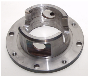
Рис. 6. Вилка карданної муфти вагона метро
