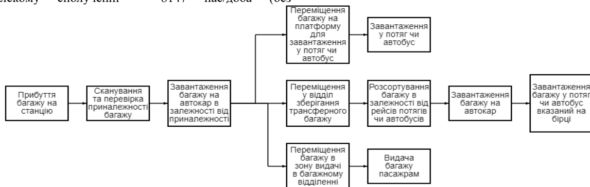
Рис. Структурно-логічна схема обробки багажу (термінового вантажу) у випадку сканування та перевірки багажу
