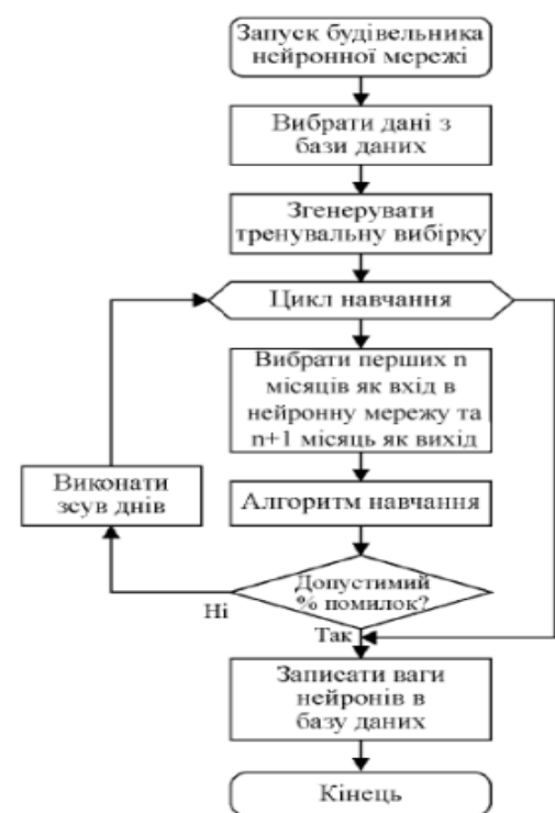
Рисунок 2.5 – Загальний алгоритм навчання моделі прогнозування на основі апарату нейронних мереж [78]
