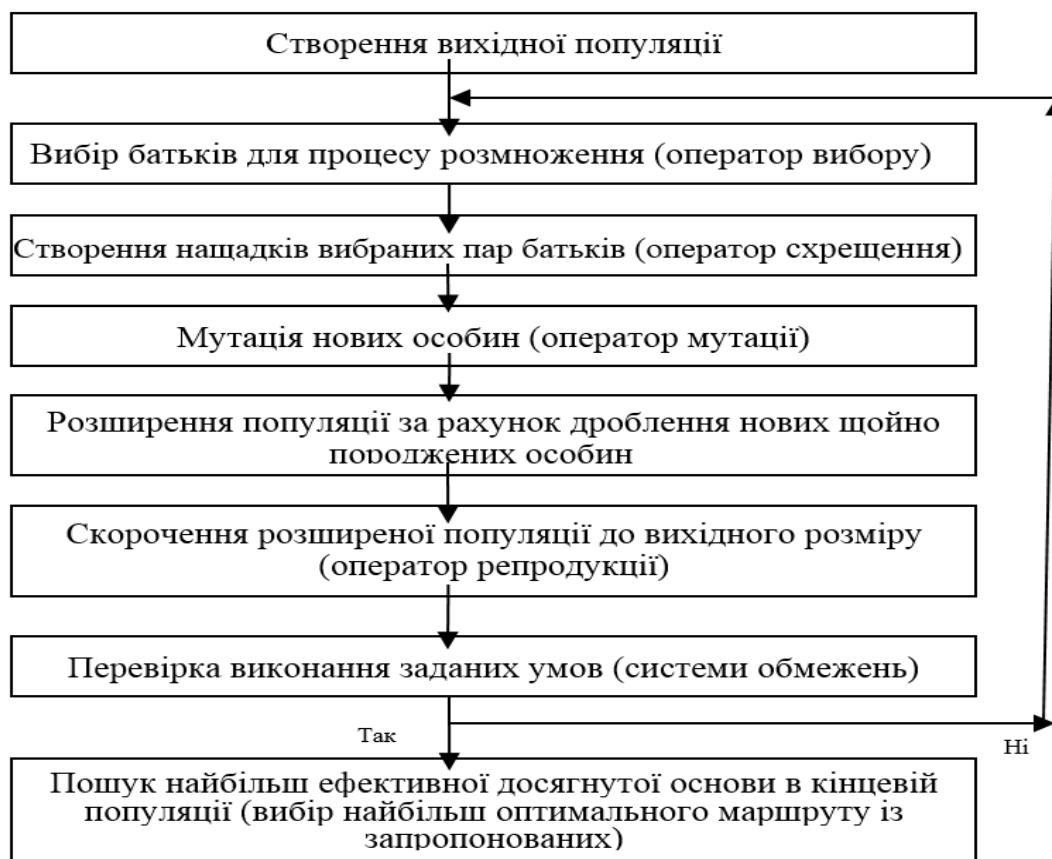
Рисунок 3.6 – Загальний алгоритм роботи ГА
