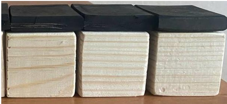
Рисунок 2.6 – Зразки композиції деревини та армованої гуми (а), подібні прокладному шару (б):
