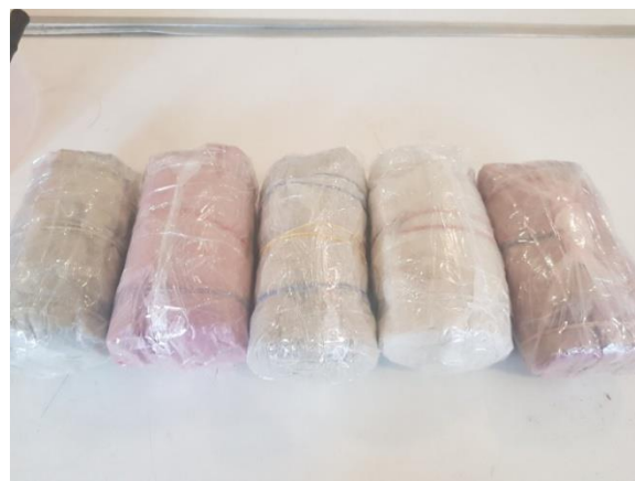
Рисунок 5.1 – Заготівля рулонного композиційного матеріалу для прокладного шару
