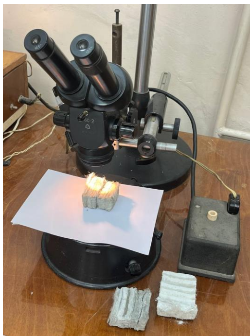
Рисунок 2.8 – Світловий мікроскоп МБС-2 зі зразками композиційного матеріалу із глиноземистого цементу і поліефірного волокна
