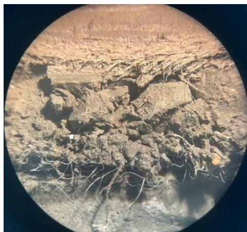
Рисунок 4.1 – Оптичні знімки зрізів композиційного матеріалу із портландцементу (а, в, д), глиноземистого цементу (б, г, е) і поліефірних волокон: а, б – добре ущільнені ділянки; в, г – задовільно ущільнені ділянки; д, е – незадовільно ущільнені ділянки з прошарками незаповненого цементним каменем волокнистого матеріалу; \times(7,5-12,5)
