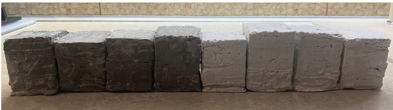
Рисунок В.2 – Зовнішній вигляд зразків дисперсно-армованого композиційного матеріалу на основі портландцементу (сірого кольору) і глиноземистого цементу (білого кольору) після 50 циклів поперемінного заморожування та відтавання. Ознак руйнування – лущення поверхні не спостерігається
