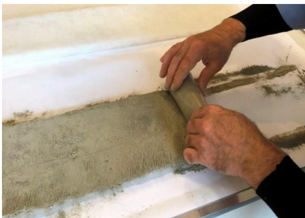
Рисунок 5.1 – Заготівля рулонного композиційного матеріалу для прокладного шару
