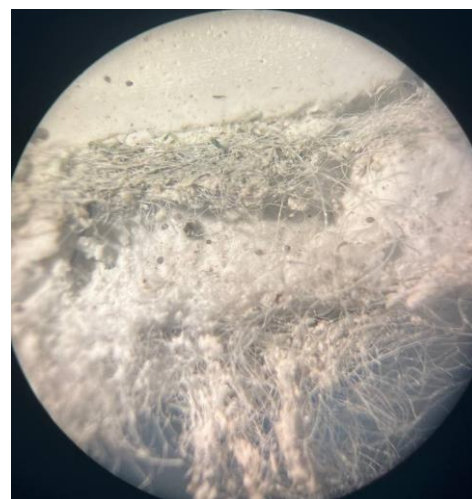
Рисунок 4.1 – Оптичні знімки зрізів композиційного матеріалу із портландцементу (а, в, д), глиноземистого цементу (б, г, е) і поліефірних волокон: а, б – добре ущільнені ділянки; в, г – задовільно ущільнені ділянки; д, е – незадовільно ущільнені ділянки з прошарками незаповненого цементним каменем волокнистого матеріалу; \times(7,5-12,5)
