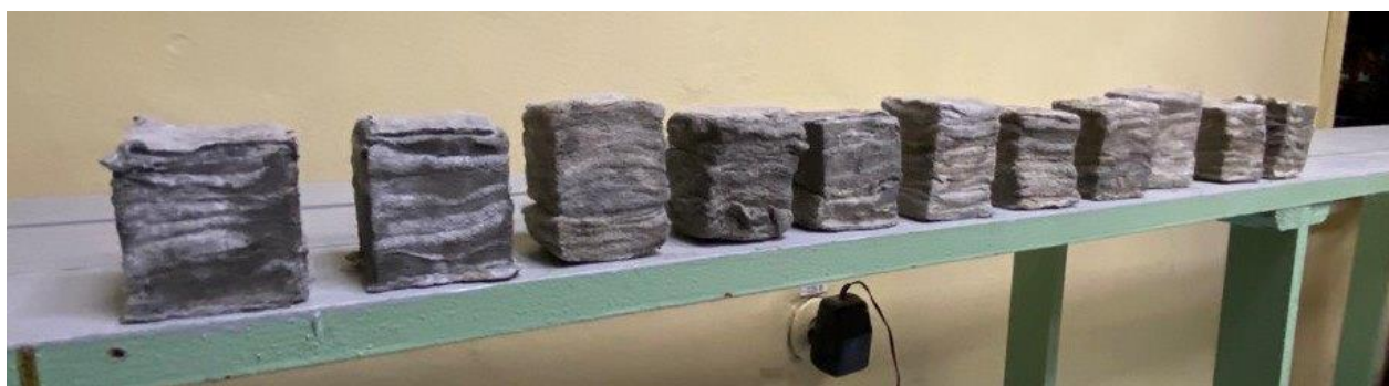
Рисунок 2.4 – Зразки композиційного матеріалу: а – поміщені в контейнер для твердіння; б – готові для випробувань
