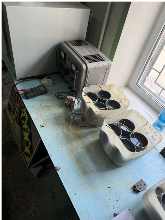
Рис. 2.5 Загальний вигляд лабораторної установки дослідження спільного впливу рідкого середовища та електричного поля на конструкційні матеріали
