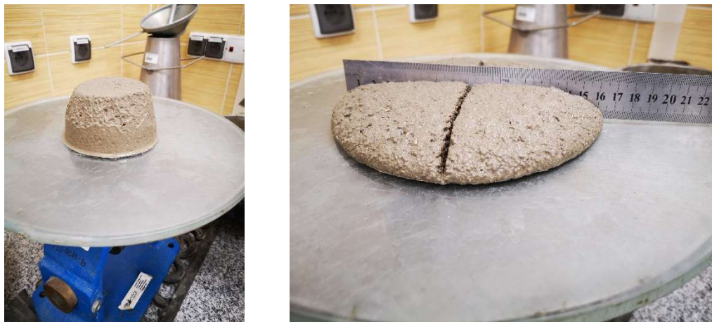
Рис. 4.1 Визначення консистенції свіжого розчину за допомогою струшувального столика згідно ДСТУ Б В.2.7-124-2004
