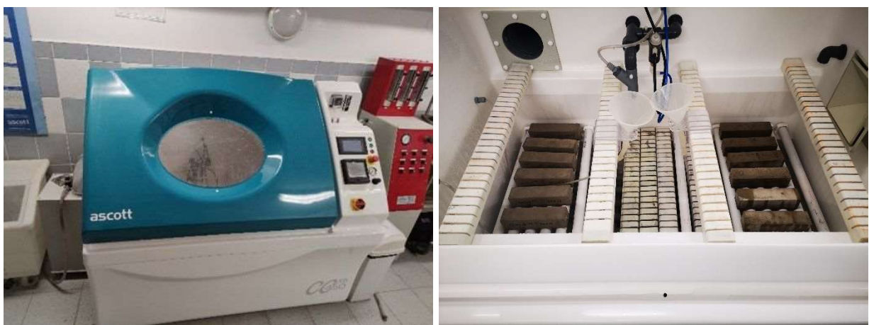
Рис. 2.4 Камера соляного туману Ascott лабораторії кафедри будівельної фізики та будівельних матеріалів Західнопоморського технологічного університету в Щецині (Польща)
