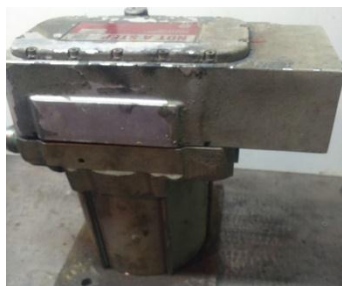
Фото 1 Паливний насос із Перетворювачем
