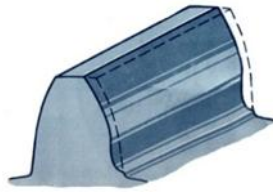
Рис. 4 Абразивне зношування зуба
