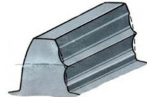
Рис. 5. Пластична плинність матеріалу поверхні зуба
