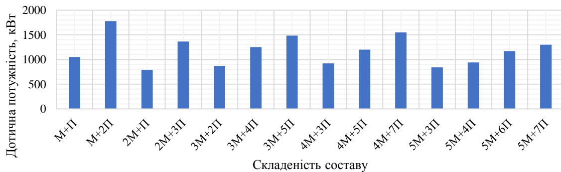
Рис. 1. Потужність моторного вагону М – моторний вагон, П – причіпний (немоторний)
