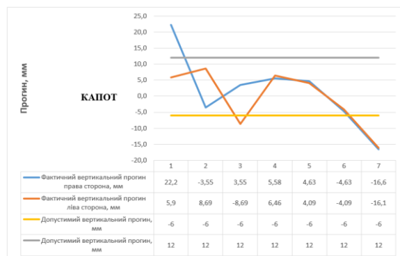
Рис 2 – Діаграми вимірювання величин прогину лівих та правих основних поздовжніх балок дрезин типу ДГКу
