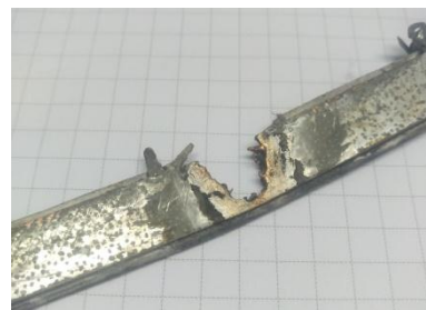
Фото 3 Характерний пробій до КЗ струмоведучої шини
