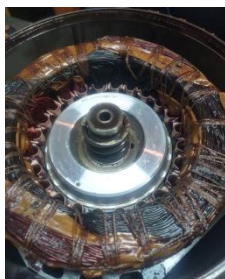
Фото 2 Пошкоджена обмотка статора
