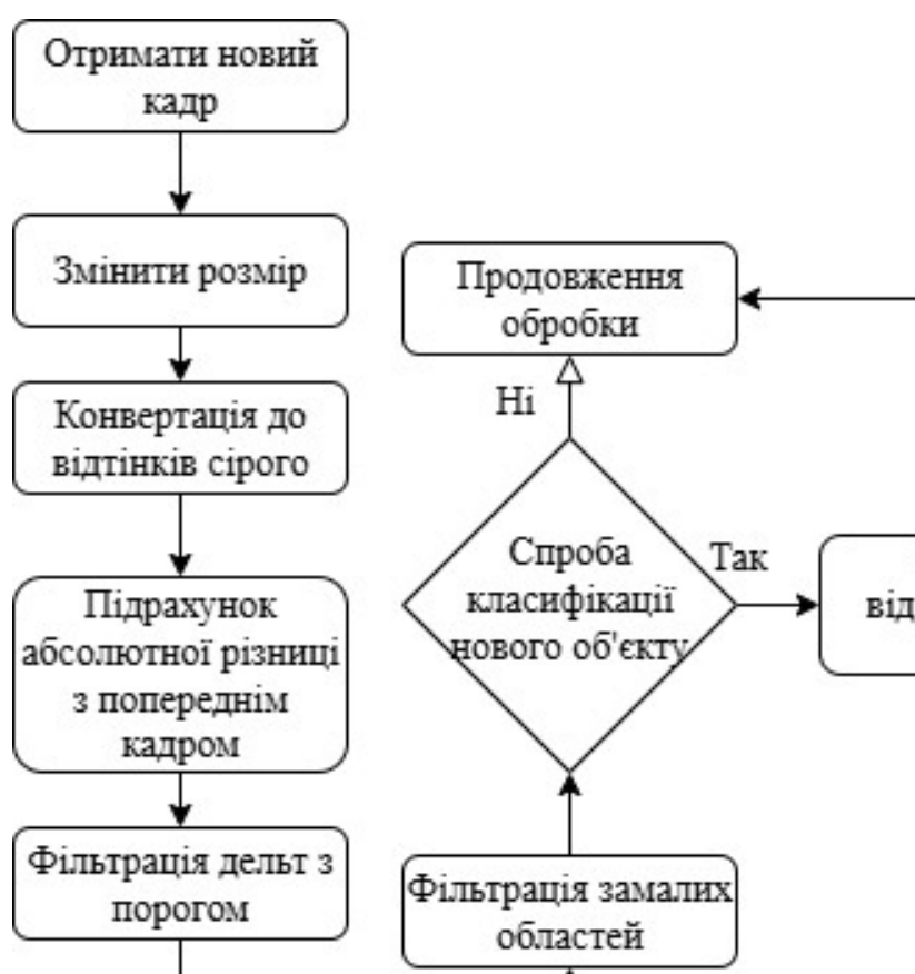
Рисунок 2.4 – Блок-схема алгоритму виявлення об'єктів у відеопотоці
