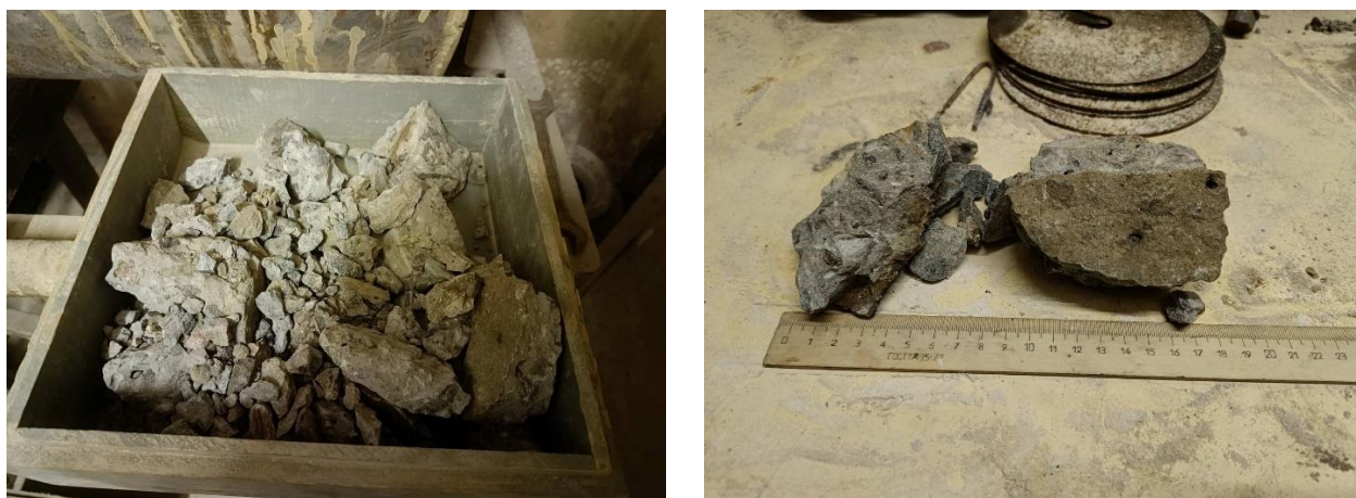
Рис. 2.1. Загальний вигляд залишків залізничних залізобетонних шпал
