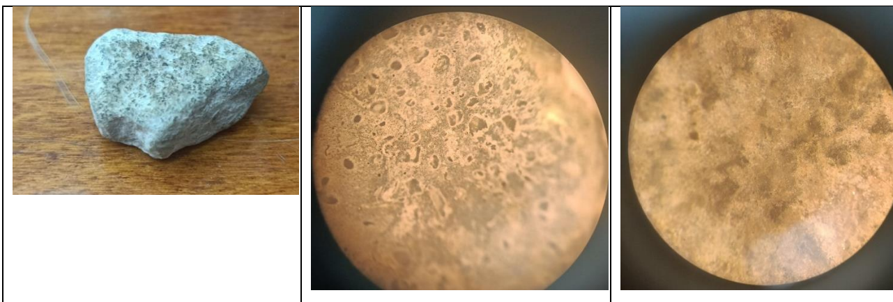
Рис. 4.37. Оптичні знімки при збільшенні \times 50 поверхні рециклінгового заповнювача фракції 20 мм після просочення силікатом натрію
