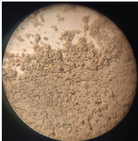
Рис. 4.34. Оптичні знімки поверхні заповнювачів, отриманих після подрібнення шпал фракцій: a – 20 мм; б – 10 мм; в – 5 мм; г – 2,5 мм; д – 1,25 мм; е , ж – 0,63 мм; и – 0,315 мм; к – 0,14 мм; л – менше 0,14 мм
