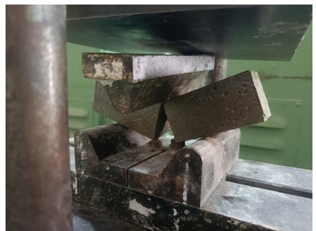
Рис. 4.19. Загальний вид зразків цементно-піщаного розчину із рециклінговим заповнювачем цементним пилом
