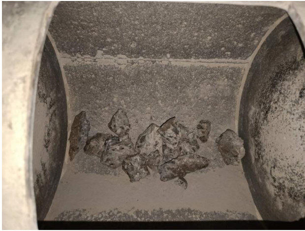
Рис. 4.10. Механічне очищення заповнювачів у барабанному млині
