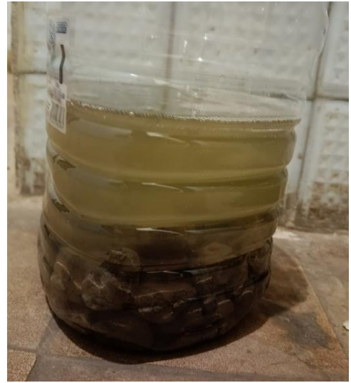
Рис. 4.11. Просочення заповнювачів розчином силікату натрію
