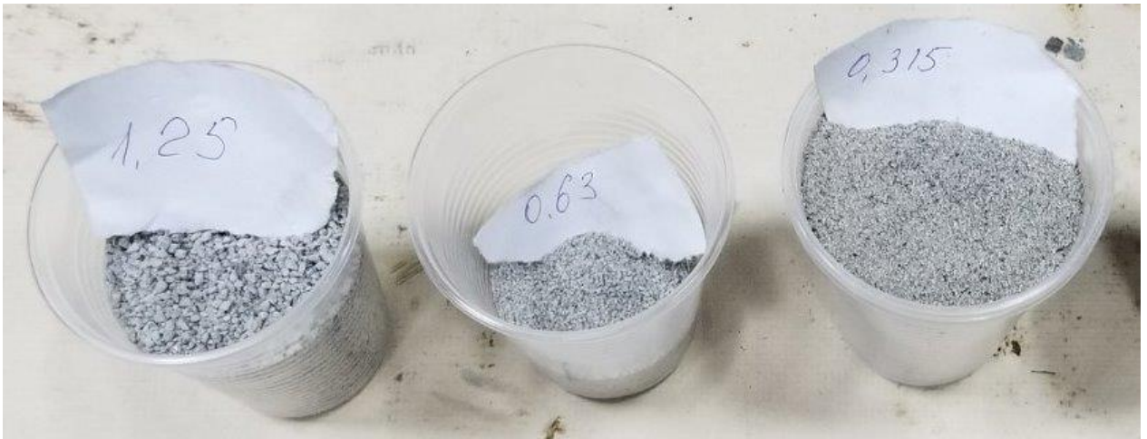
Рис.2.7. Отримані розробленим способом зерна фракції 0,315-5 мм
