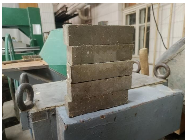
Рис. 4.19. Загальний вид зразків цементно-піщаного розчину із рециклінговим заповнювачем цементним пилом
