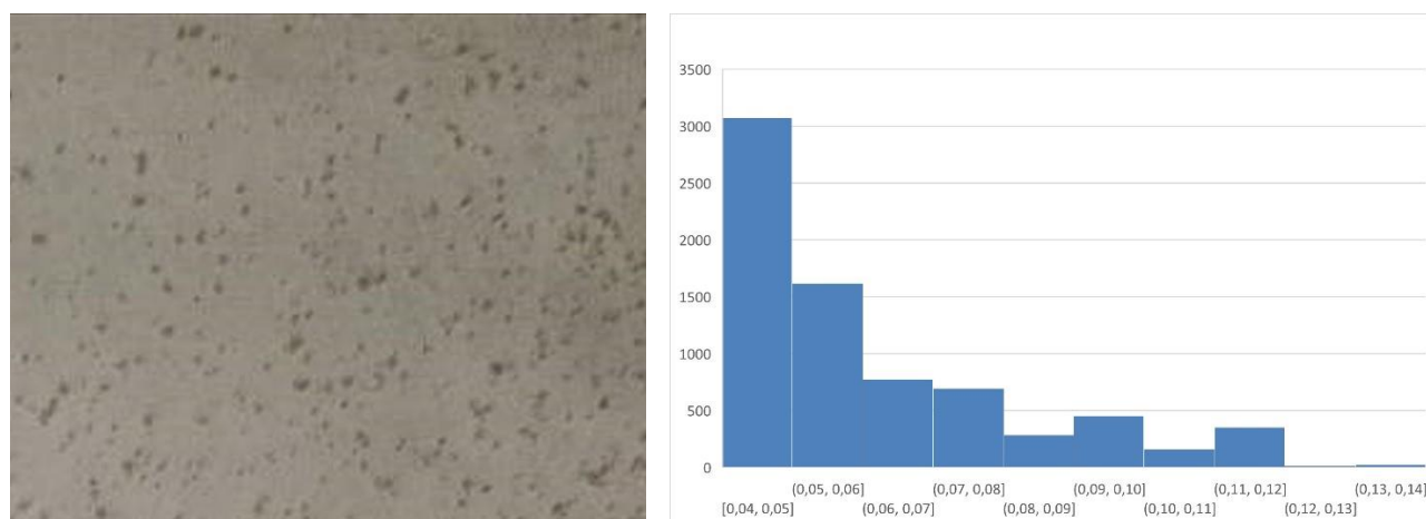
Рис. 4.7. Фото частинок, які пройшли крізь сито 014, (ліворуч) і гістограма їх розподілу за розмірами у міліметрах (праворуч)
