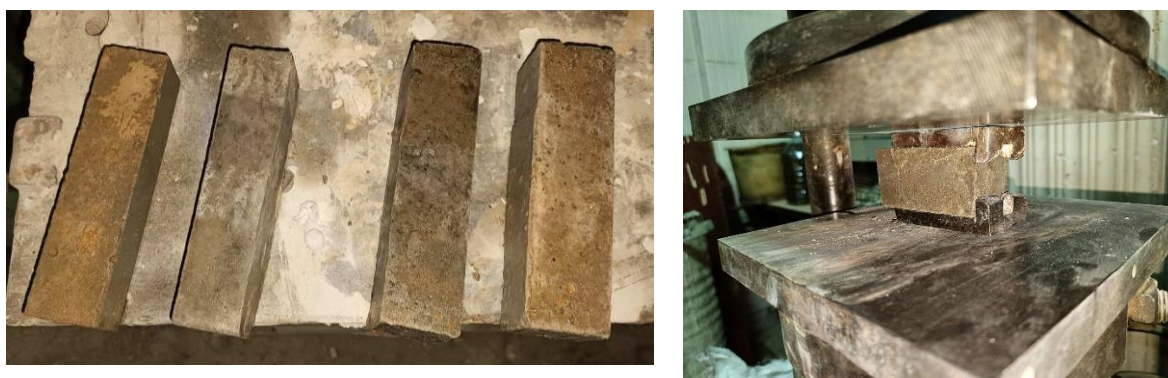
Рис. 4.16. Загальний вид зразків цементно-піщаного розчину із рециклінговим заповнювачем піском
