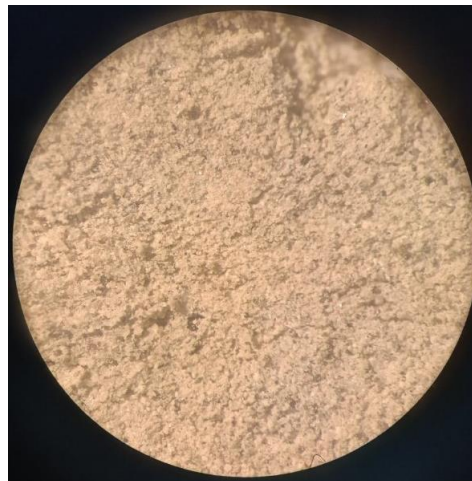
Рис. 4.34. Оптичні знімки поверхні заповнювачів, отриманих після подрібнення шпал фракцій: a – 20 мм; б – 10 мм; в – 5 мм; г – 2,5 мм; д – 1,25 мм; е , ж – 0,63 мм; и – 0,315 мм; к – 0,14 мм; л – менше 0,14 мм
